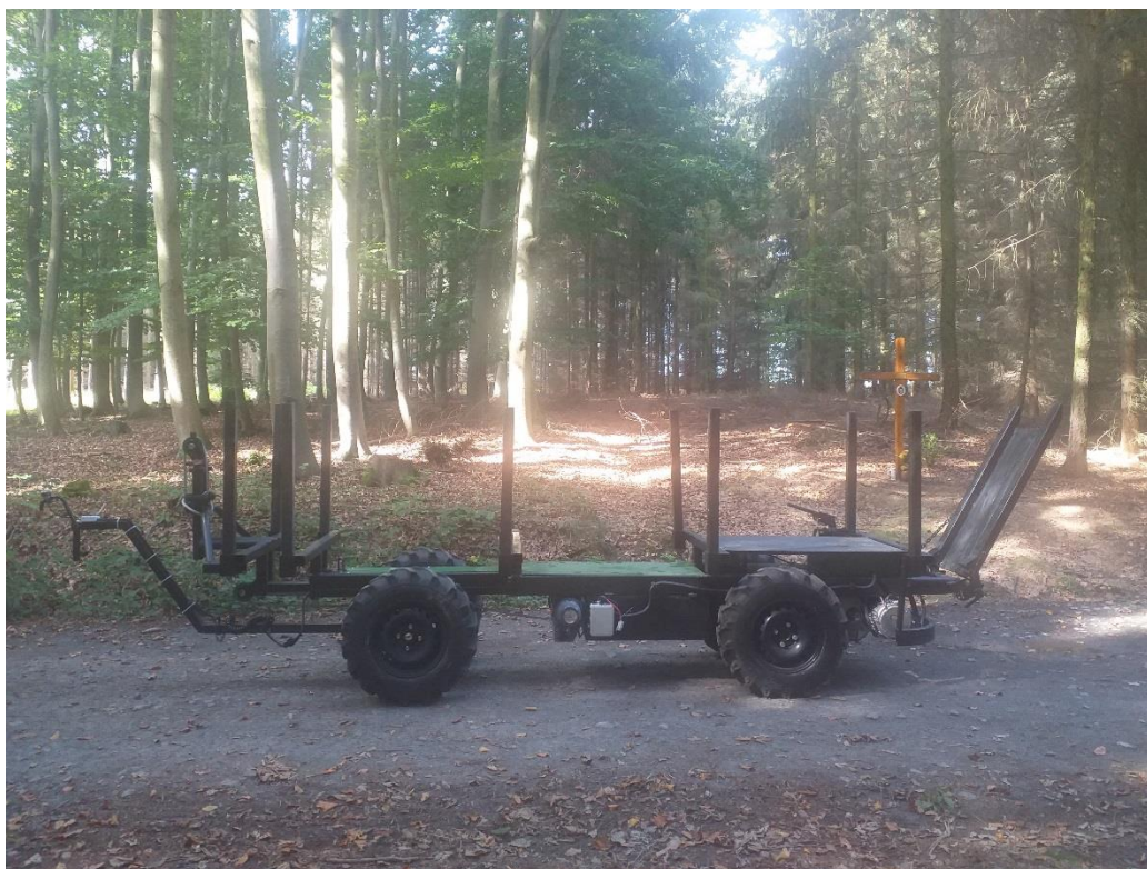
Obrázek 1 - Popsaný elektrický vyvážecí stroj, který byl použit při této diplomové práci (autor: T. Buchar)
