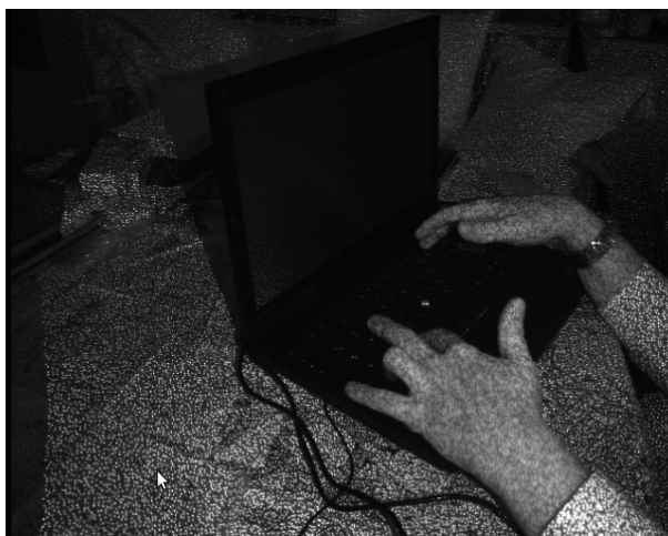
Obrázek 9: Infračervený snímek ukazující rozložení laserových bodů z Kinectu, převzato z [14].
