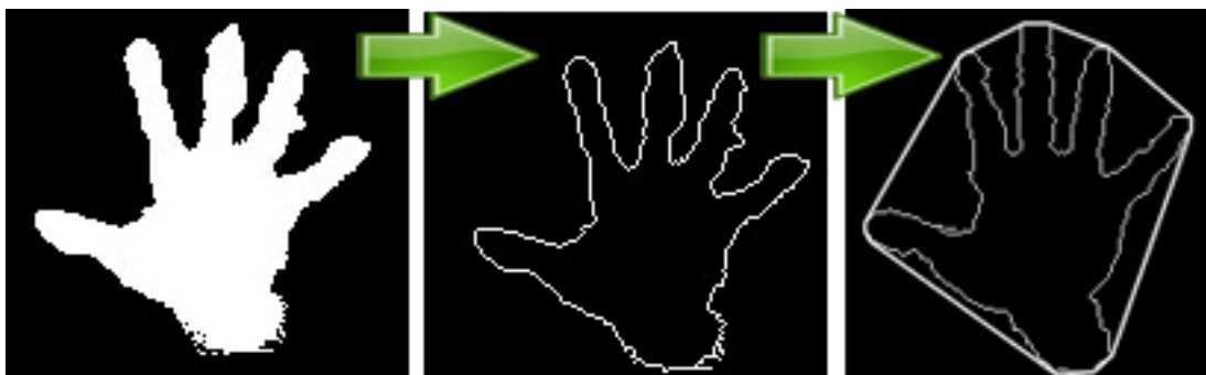
Obrázek 45: Ukázka převedení extrakce ruky (vlevo) na konturu (uprostřed) a poté přidání konvexní obálky pro detekci prstů (vpravo).
