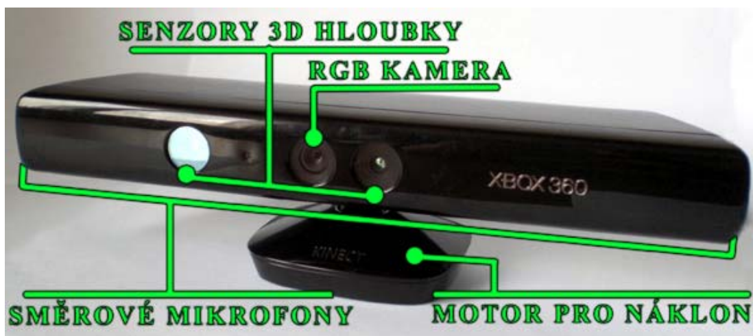
Obrázek 11: Schéma konzole Kinect.
