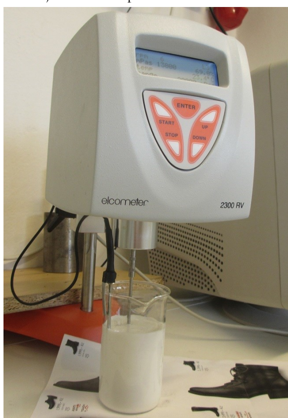
Obr. 19 Měření viskozity lepidla Cascol 3326 přístrojem Elcometer 2300 RV (Vlastní práce)
