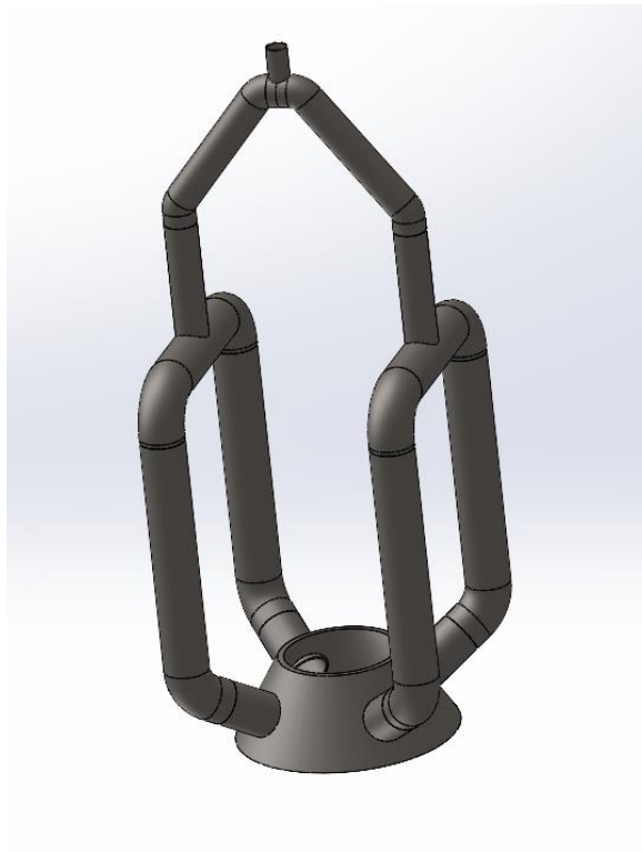
Obrázek č. 40 - Podsestava (Sestava1) funkčního celku kychta s potrubím na odvod vysokopevního plynu
