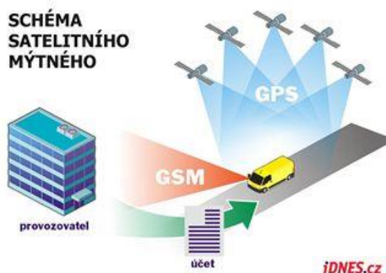
Obr. 10 Schéma satelitního mýtného (zdroj: http://technet.idnes.cz/jak-bude-fungovat-satelitni-mytne-v-cesku-f1y-/tec/technika.aspx?c=A070813_115915_tec_technika_NYV )
