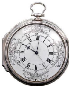
Obr. 5 Kapesní chronometr H4 vyrobený roku 1779 (zdroj: https://www.asme.org/engineering-topics/articles/mechanisms-systems-devices/john-harrison )
