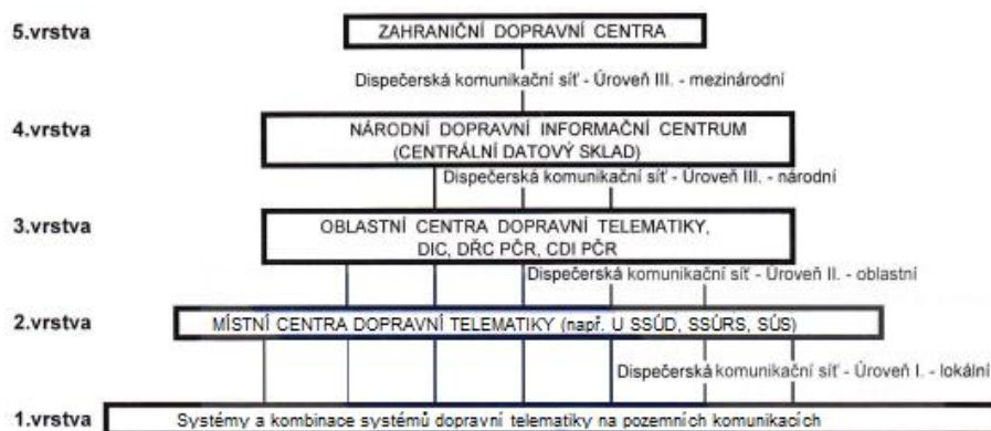
Obr. 7 Hierarchické uspořádání architektury ITS (zdroj: http://www.pjpk.cz/TP%20182.pdf )
