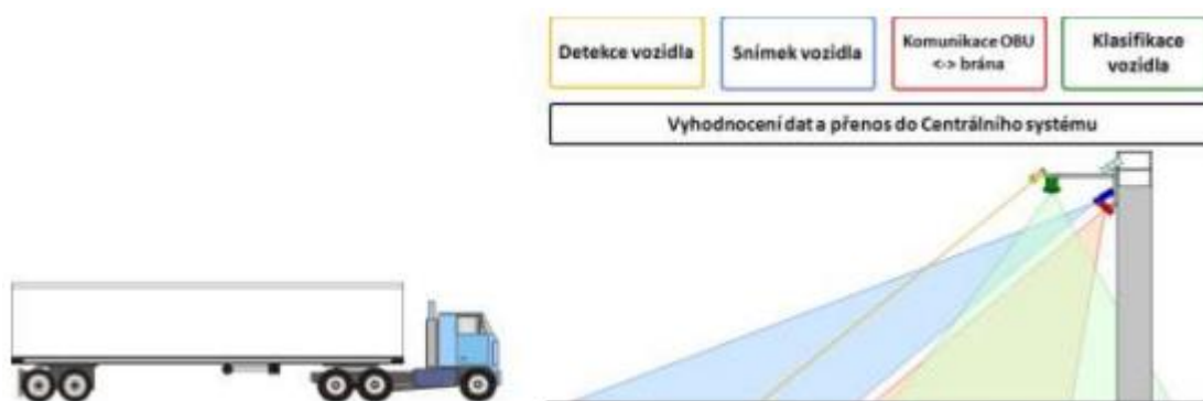
Obr. 8 Schéma detekce vozidla pod mýtnou bránou (zdroj: http://www.dopravniinfo.cz )
