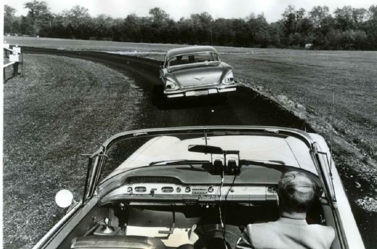
Obrázek 2.2: Zabudovat do silnice ocelový drát, který by sledovaly zabudované magnety v automobilu. Zde vyobrazena „Autonomous Highway System“, jedna z vizí 50. let 20. století. 3
