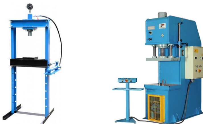
Obr. 4: Vlevo lis PROMA HLR 12 se silou 120 kN[12], vpravo lis SICMI PCL 200 A se silou 2000 kN[15].
