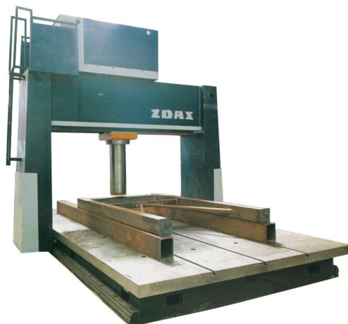
Obr. 5: Portálový rovnací lis ŽDAS CDN 400[9]
