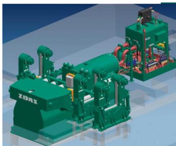
Obr. 6: Rovnací lis na tyčový materiál ŽDAS CDT 1000[9]
