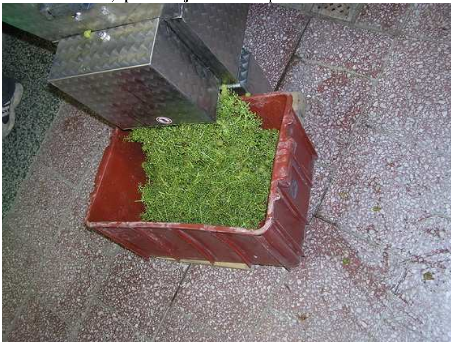
Obrázek 22: Bedna, upotřebená jako sběrač stopek z odzrňovače
