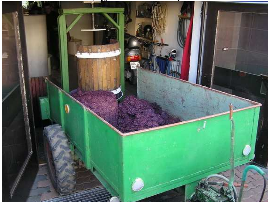
Obrázek 36: Rozebrání lisu, vyjmutí mláta a odvod zpět do vinice
