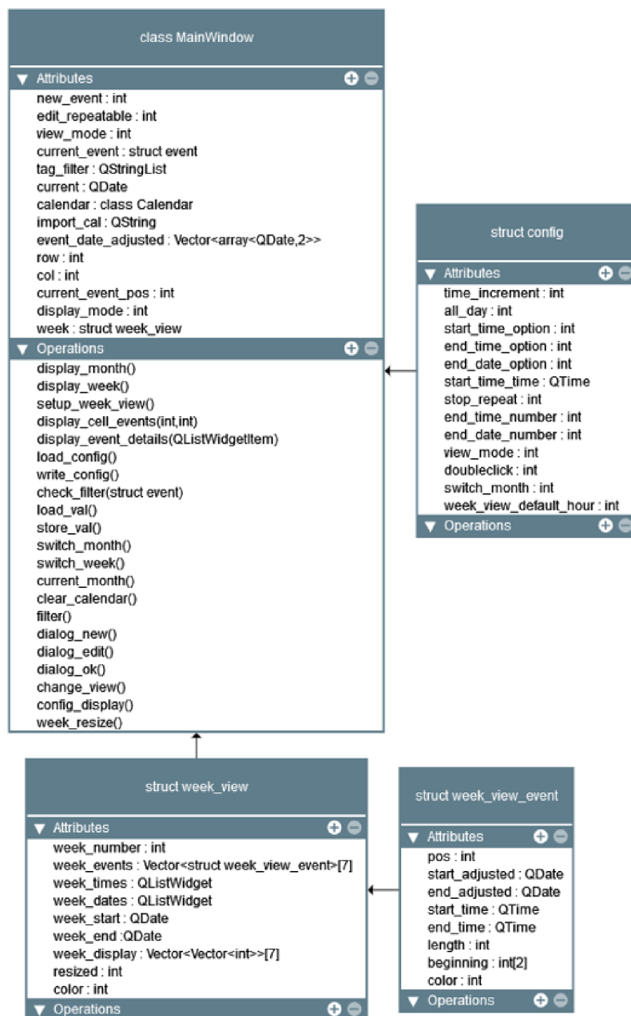
Obrázek 3.5: Diagram třídy MainWindow a jejích struktur
