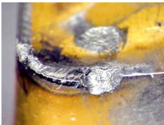
Obr. 2.4 Typické opotřebení nástroje při soustružení superslitin [15].
