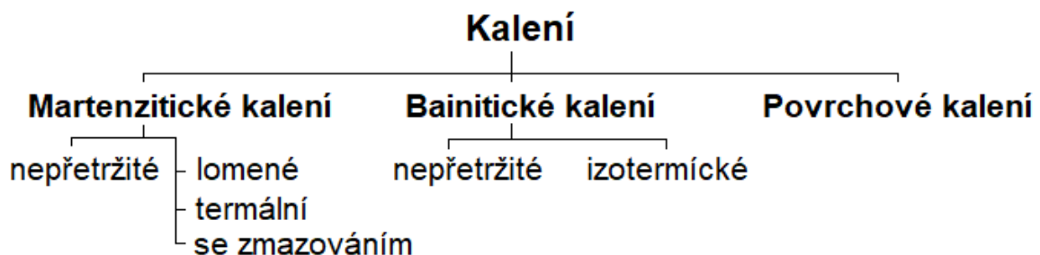
Obr. 3.1 Rozdělení způsobů kalení.
