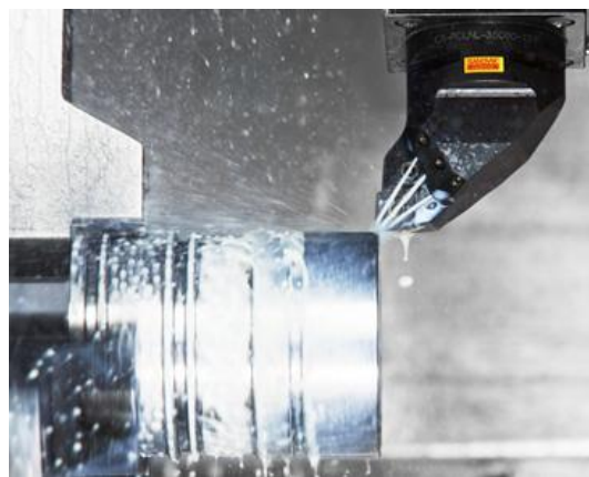
Obr. 2.5 Použití přesného přívodu procesní kapaliny [15].
