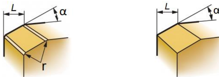
Obr. 5.1 Provedení ostří typu S (vlevo) a typu T (vpravo) u VBD z KNB a rezné keramiky od společnosti Sandvik Coromant – podle [44].
