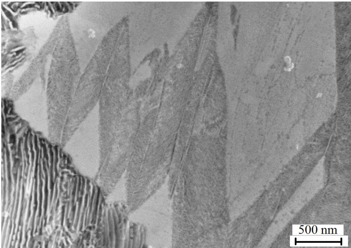
Obrázek 85: Elektronová mikroskopie, slitina s 3 hmot. % C, jádro s perlitem a martenzitem, 30 000x
