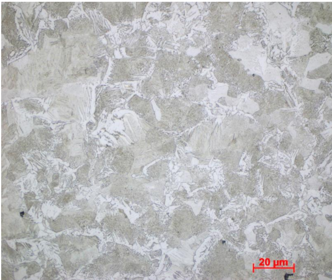
Obrázek 62: Slitina s 0,2 hmot. % C, kalena z vysoké kalící teploty, střed, 1000x
