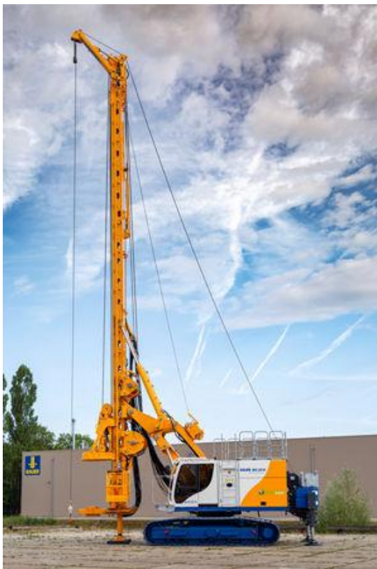
Obrázek 24: Vrtná souprava Bauer BG20H pro provádění pilot [18]
