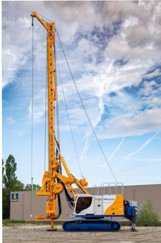
Obrázek 24: Vrtná souprava Bauer BG20H pro provádění pilot [18]
