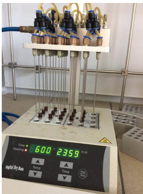
Obr. č. 14: Odpařované vialky se supernatantem v dusíkové atmosféře (foto Daňková)
