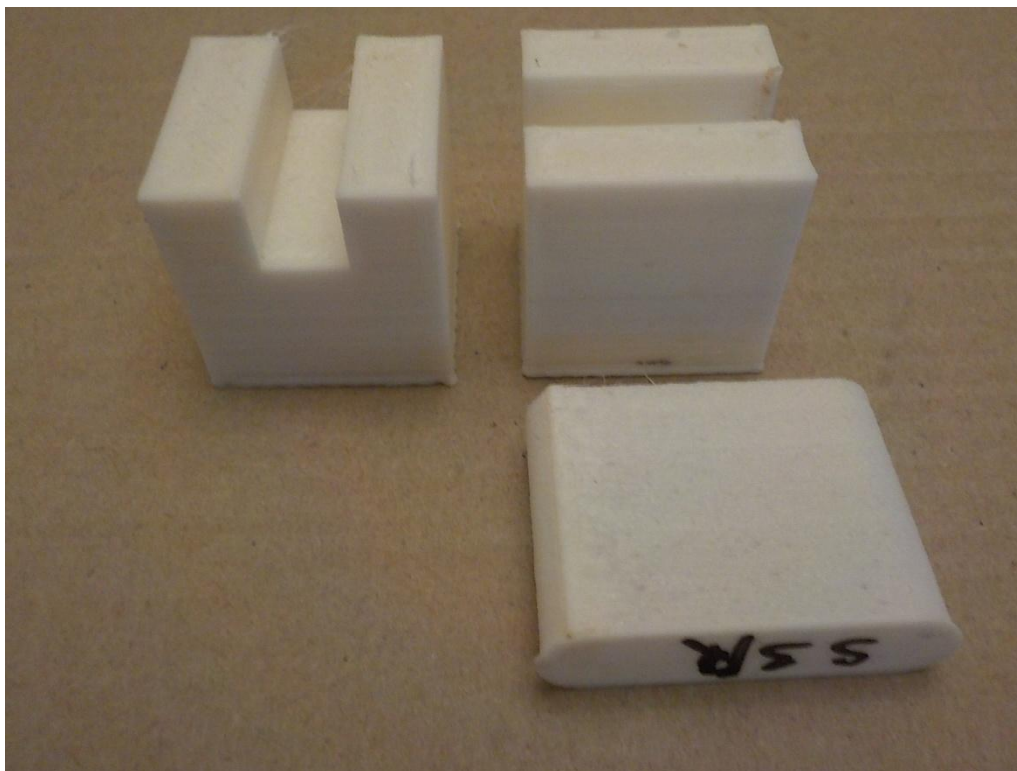
Obr. 3.28: Testovací objekty vytištěné po úpravě osy Z
