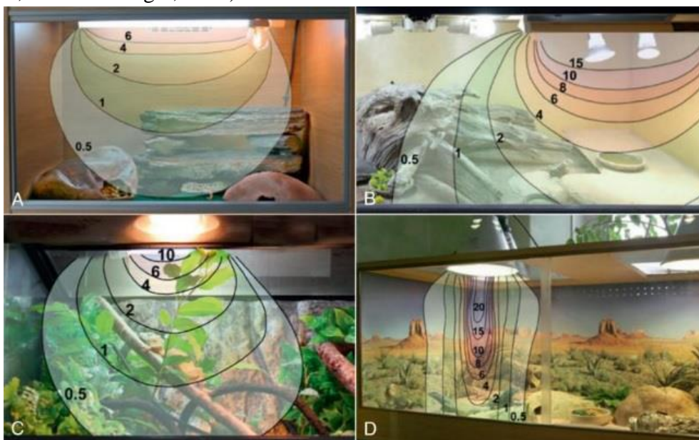
Obrázek 6 Pokles UV záření znázorněn čarami s čísly, A-zářivka T8 5 % UVB, B-zářivka T5 12 % UVB, C-kompaktní zářivka 6 % UVB, D-halogenová lampa 150 W UVB (Divers a Stahl, 2019).
