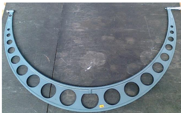
Obrázek 1 Měřidlo třmenový mikrometr o rozsahu 900–1000 mm obchodní značky Mitutoyo
