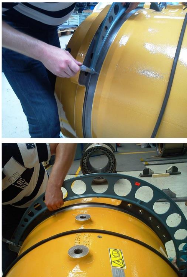
Obrázek 3 Zachycení průběhu měření za pomoci měřidla třmenový mikrometr obchodní značky Mitutoyo
