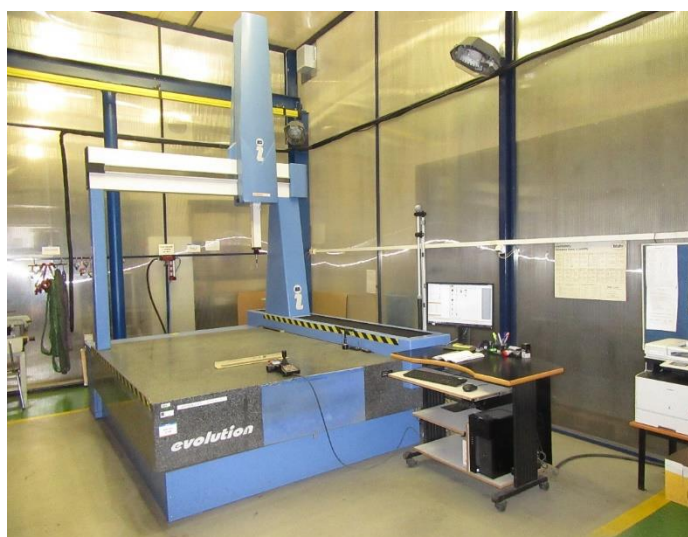
Obrázek 4 Měřicí zařízení 3D měřicí zařízení 3D-CMM-LK Evolution 20.15.12.
