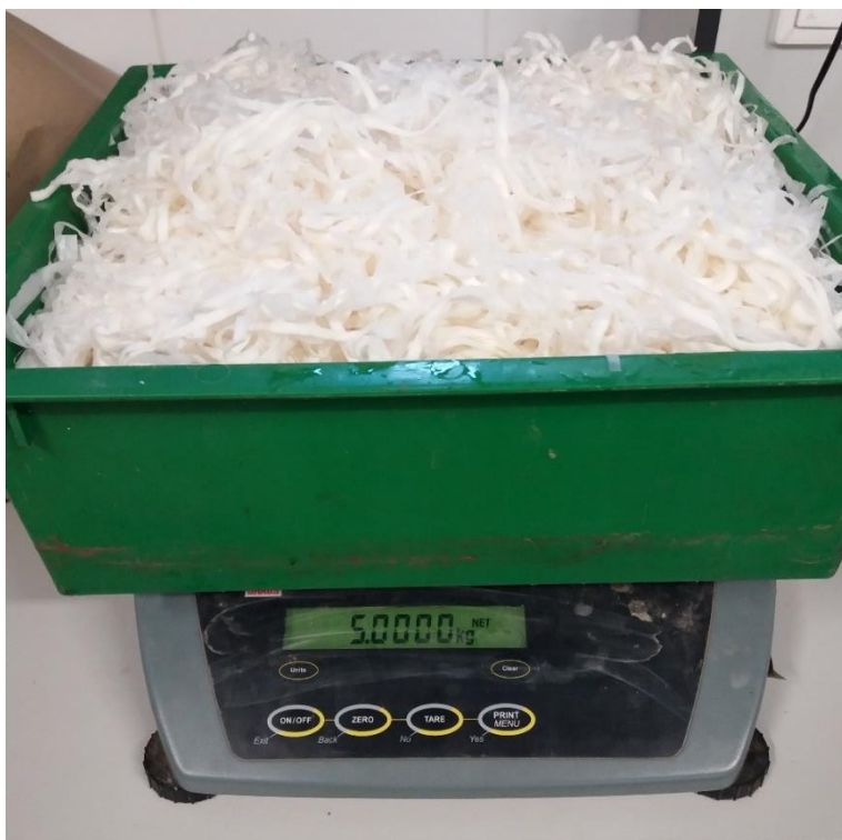
Obr. 7: Založení pokusu – varianta 100 % papír (foto vlastní).
