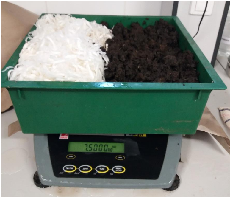
Obr. 9: Založení pokusu – varianta 50 % papír + 50 % koňský hnůj (před smícháním) - (foto vlastní).
