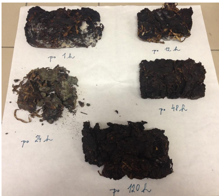
Obr. 9: Vzorčky v průběhu procesu ze zařízení GG – varianta I. (vstupní substrát + samotný papír) (foto vlastní).
