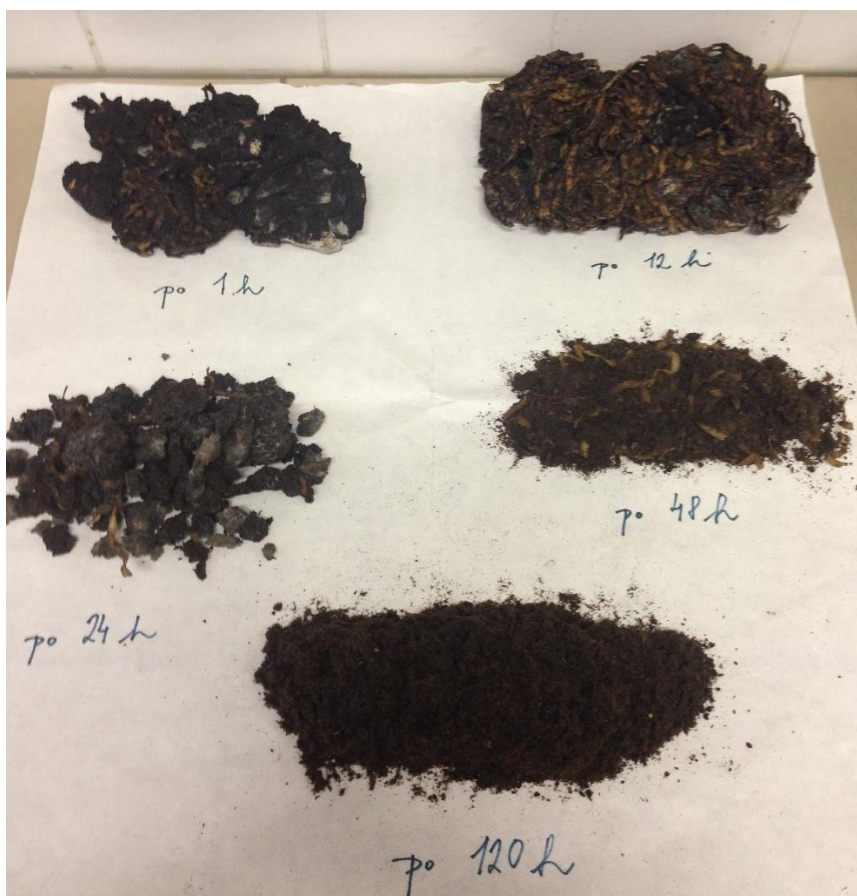
Obr. 10: Vzorčky v průběhu procesu ze zařízení GG – varianta II. (vstupní substrát + papír + jablečné výličky) (foto vlastní).
