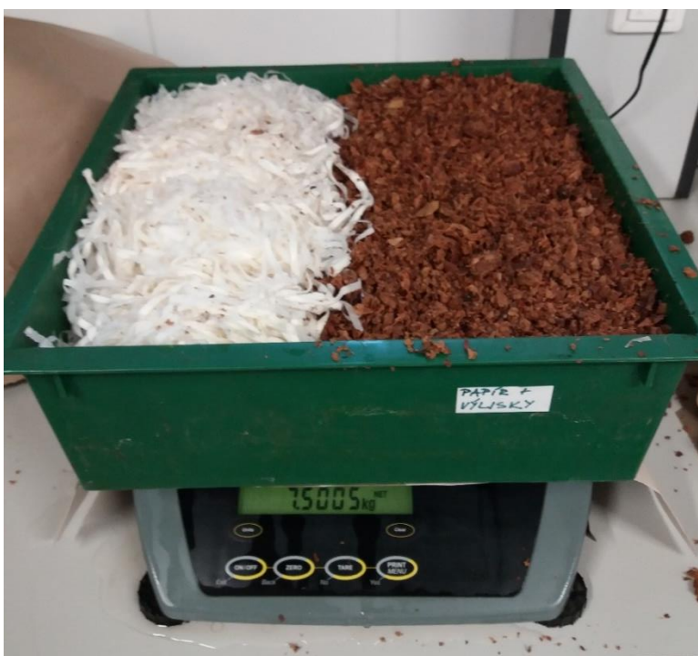
Obr. 8: Založení pokusu – varianta 50 % papír + 50 % jablečné výlisky (před smícháním) - (foto vlastní).
