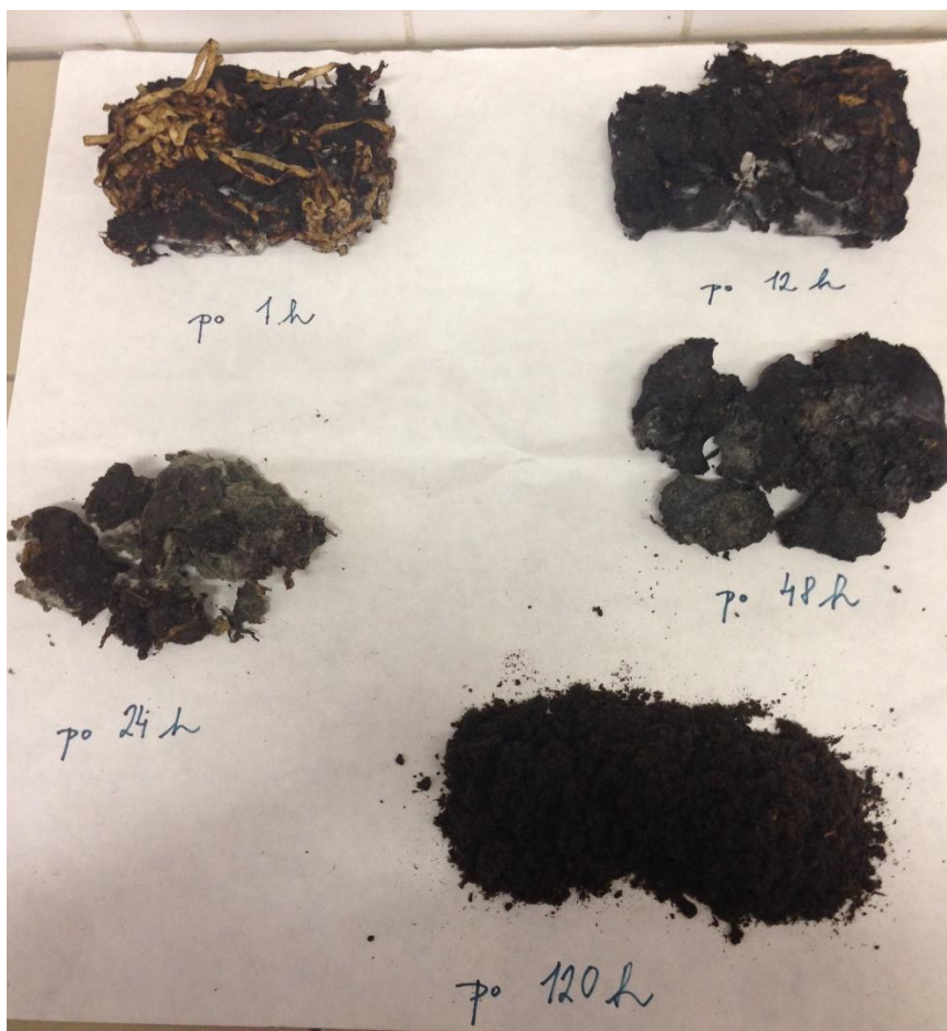
Obr. 11: Vzorčky v průběhu procesu ze zařízení GG – varianta III. (vstupní substrát + papír + koňský hnůj) (foto vlastní).
