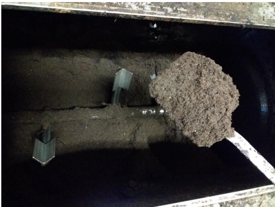
Obr. 6: Konečný produkt kompostování v kompostéru GreenGood (vstupní substrát + papír + koňský hnůj) (foto vlastní).
