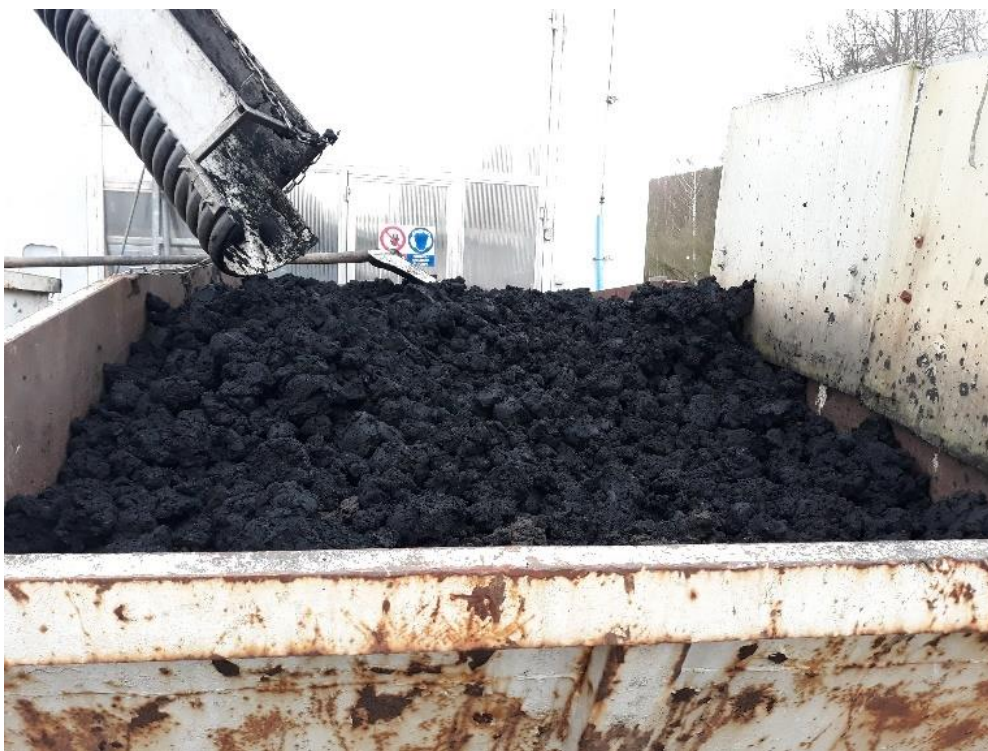
Obrázek 24: Odvodněný kal z odstředivek (sušina se pohybuje kolem 25 %)
