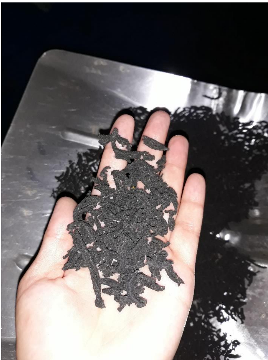
Obrázek 28: Výsledný produkt - usušený kal ve formě granulátu
