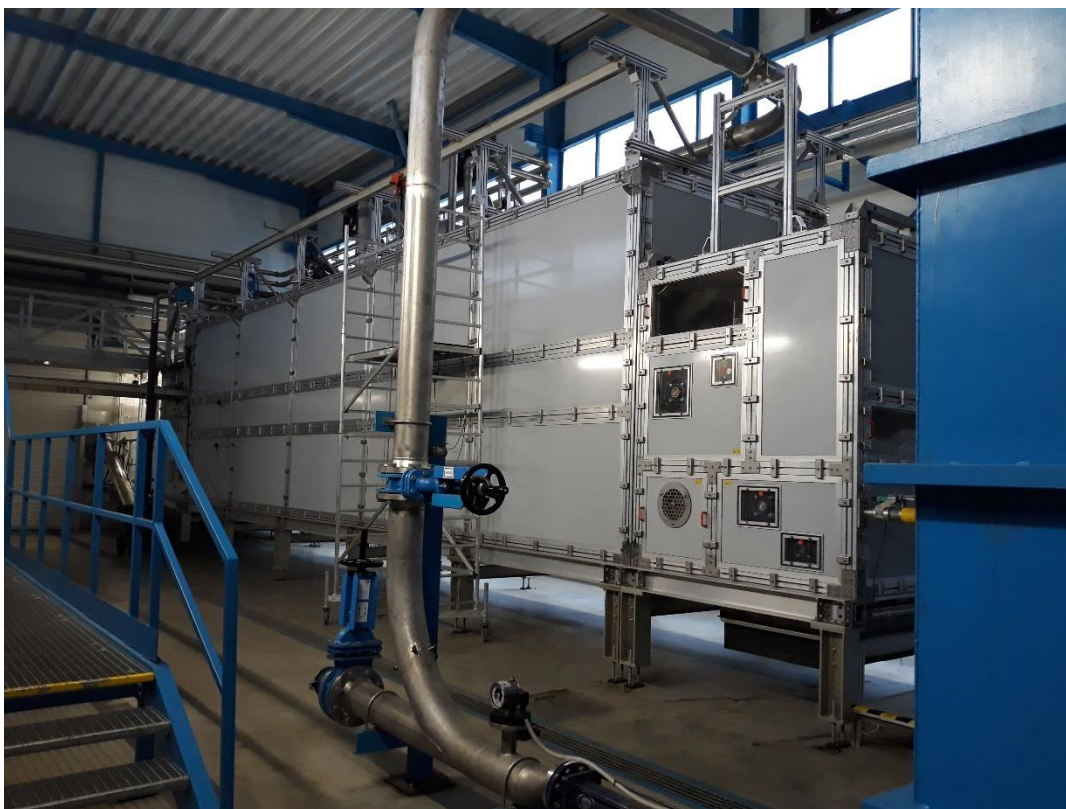
Obrázek 25: Těleso nízkoteplotní pásové sušárny
