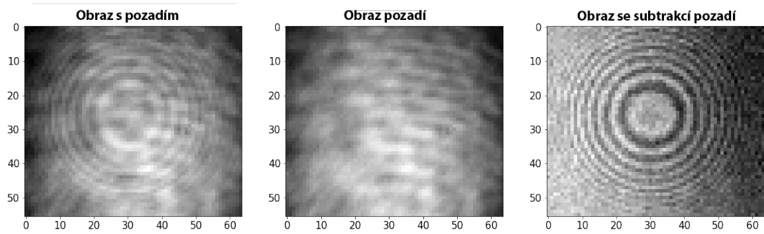
Obr. 4.13: Subtrakce nahraného pozadí bez částice od snímku s částicí.
