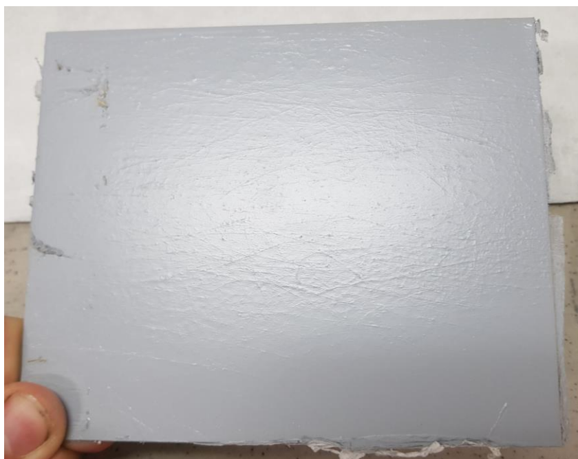
Obr. č. 26 Vzorek PA6 s příměsí zinku zvlákněný střídavým elektrickým zvlákňováním. Z obrázku č. 26 Je možné pozorovat vláknennou strukturu. Povrch je ale na omak hladký a uniformní bez rýh apod.
