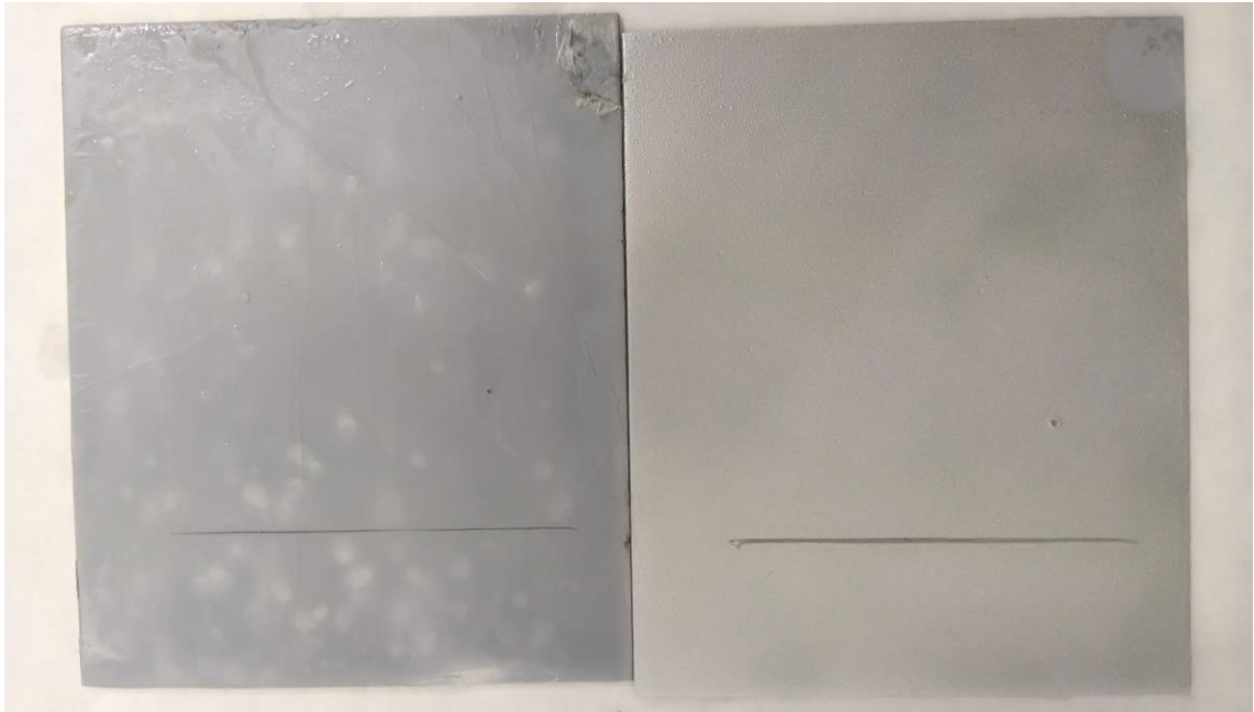
PA6, tech. elektrostatického zvlákňování, vlevo základní nástřik, vpravo všechny vrstvy
