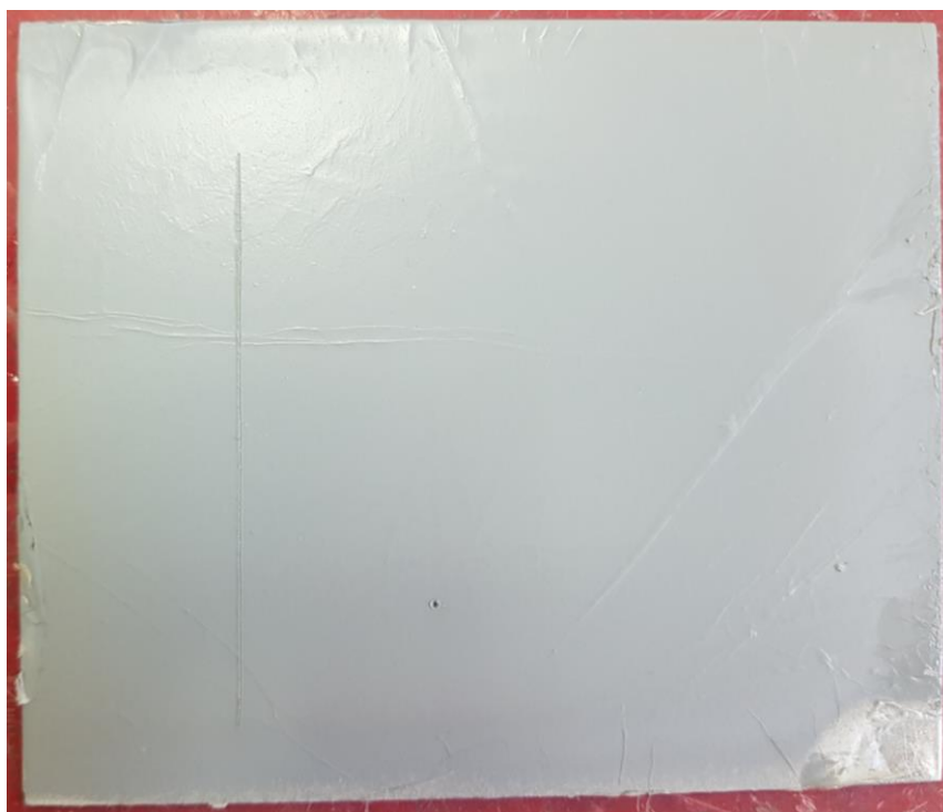
PA6, technologie elektrostatického zvlákňování, základní nástřik
