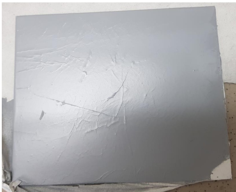
Obr. č. 25 Vzorek PA6 zvlákněný stejnosměrným el. stat. zvlákňováním na obr. č. 25 jsou vidět shrnutá vlákna od špatného nanesení vrstvy a místa shluknutých vláken. Povrch jinak nevykazuje žádné další vady.
