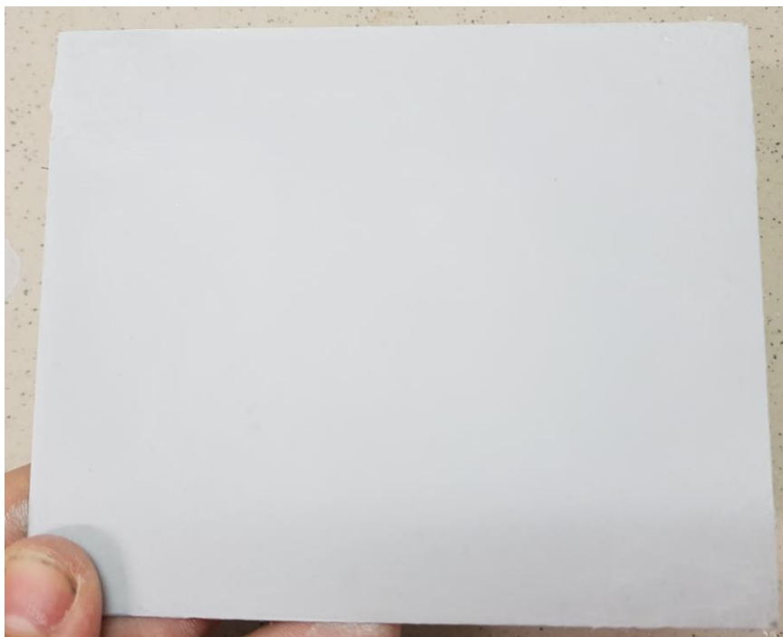
Obr. č. 27 Zbrúšený povrch stříkacího tmelu, aplikován na NT vyrobenou technologií meltblown z PP
