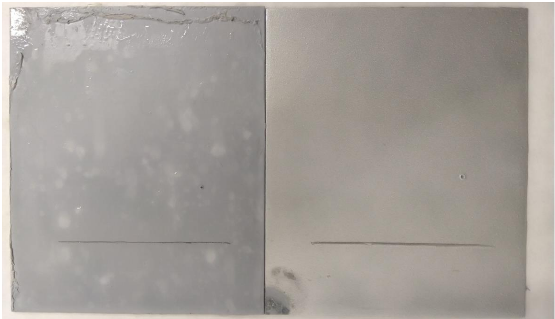
PA6, tech. střídavého elektrického zvlákňování, vlevo základní nástřik, vpravo všechny vrstvy
