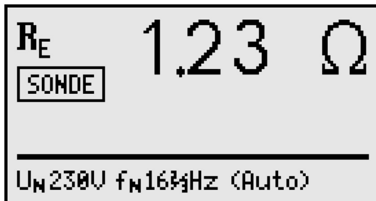
Obr. 5.2 Měření odporu uzemnění – měření se sondou
