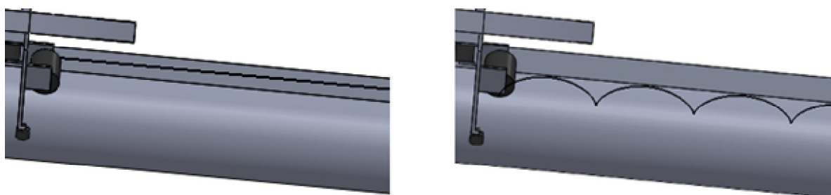
Obr. 8 Trajektorie bodu na obvodu kola při smýkání a valení
