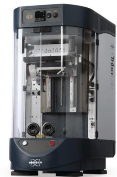
Obr. 4-3 Bruker UMT TriboLab [34].
