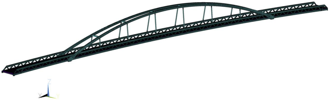
Obrázok 13: Plošný model lávky pre peších a cyklistov v Ansys Mechanical APDL
