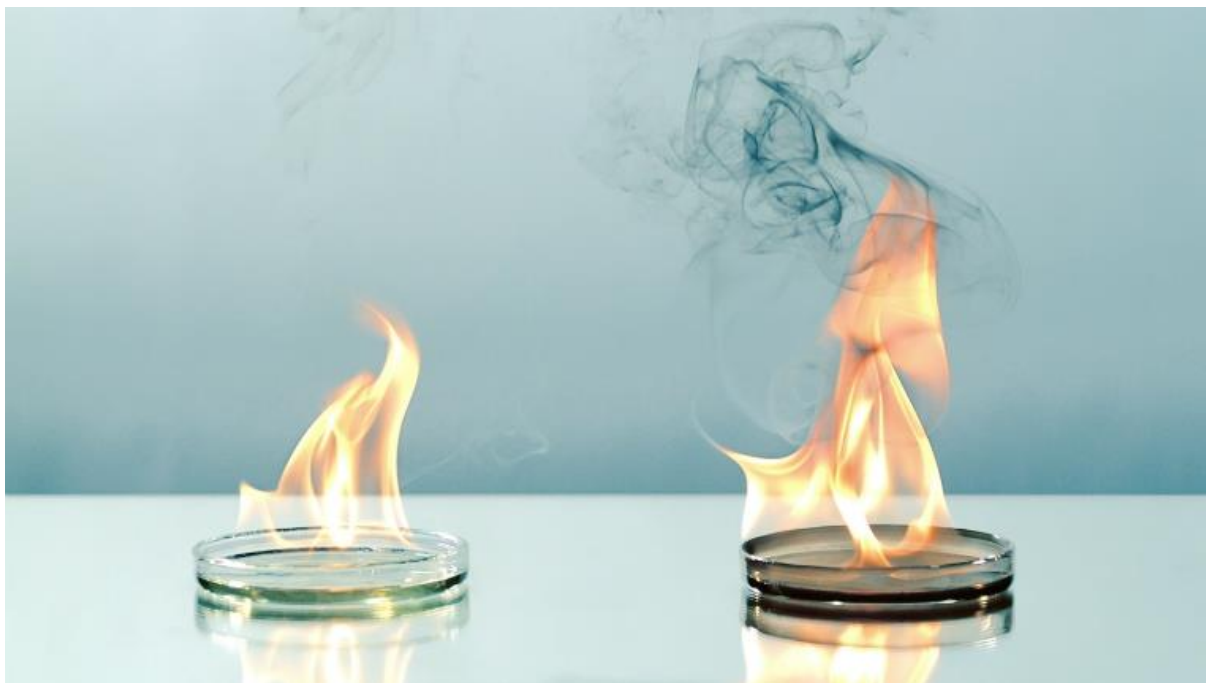
Obr. 10 Hoření 100 % HVO (vlevo) a ropné nafty (vpravo) [31]
