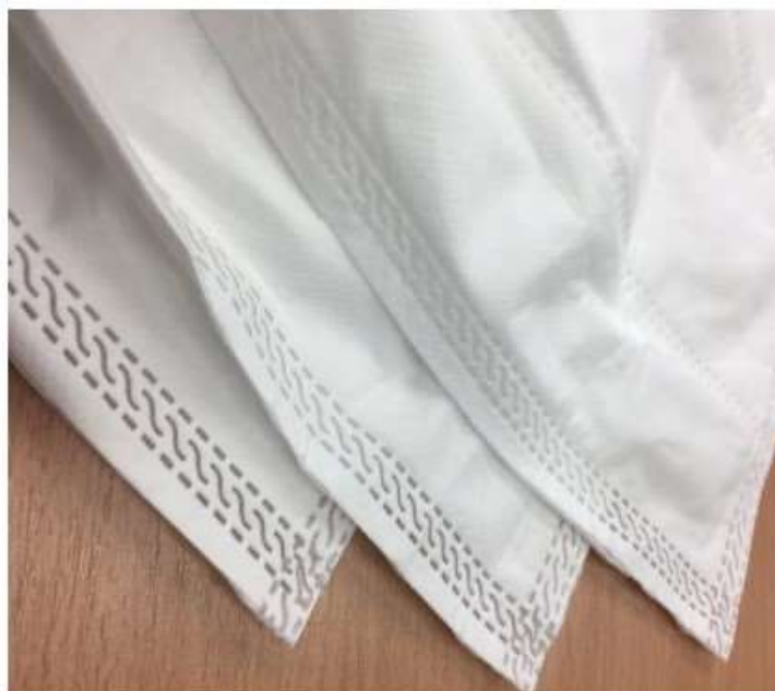
Obrázek B.13 Kapsový filtr ultrazvukově šitý [16]
