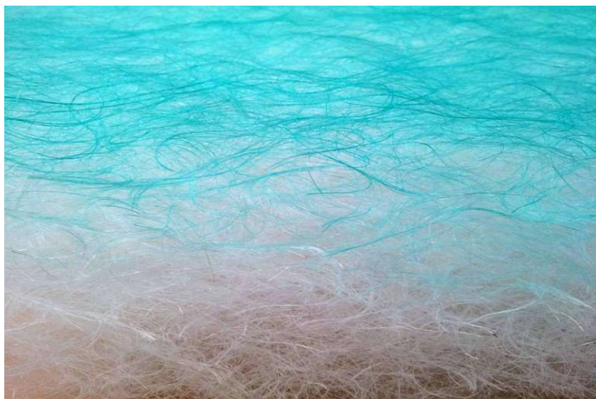
Obrázek B.10 Filtrační materiál ze skelného vlákna [11]
