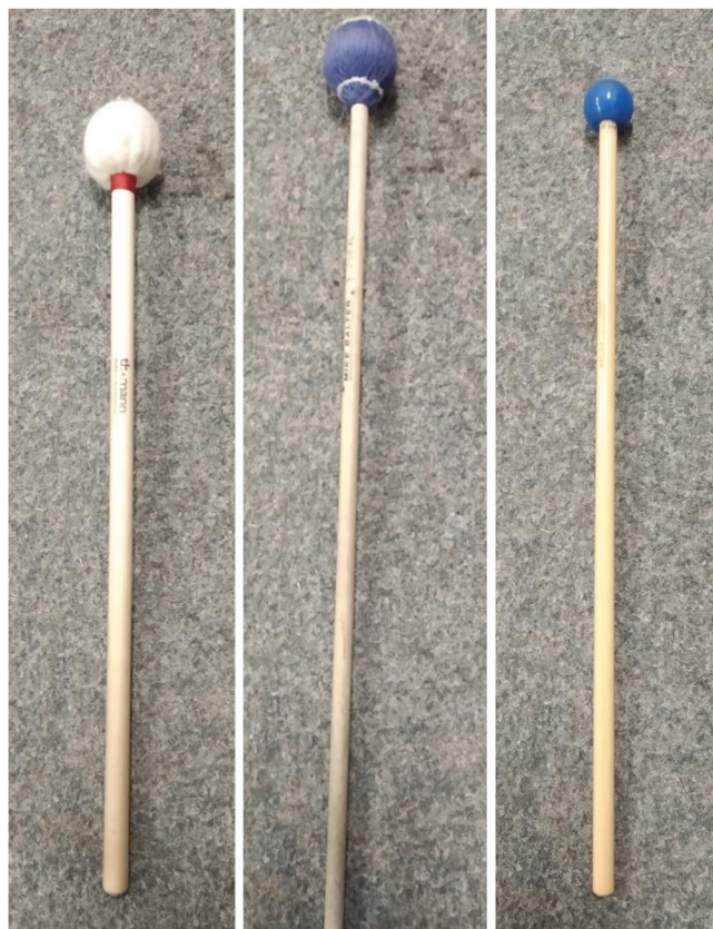
Obr. 2.1: Paličky použité pro měření zleva: měkká, středně tvrdá a tvrdá
