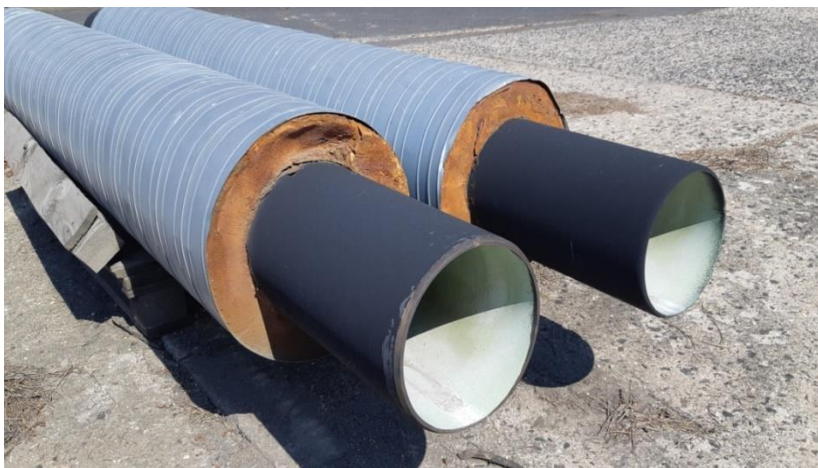
Obr. 25: Foto – materiál předizolované tvárné litiny s cementovou vystýlkou
