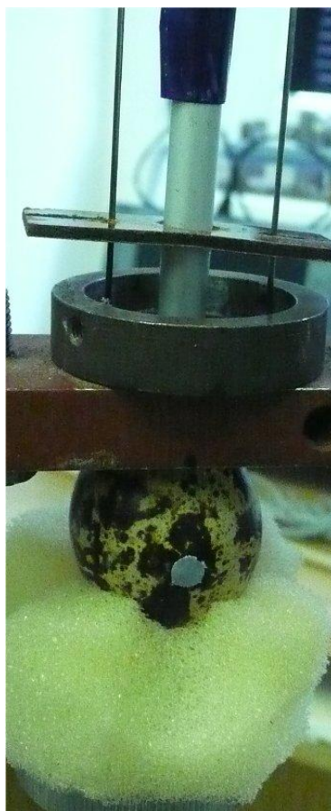
Obr. 15 Schéma rázového zatěžování vajec (levá část), na pravé straně je pohled na křepelčí vejce, na které dopadl razník, terčik je v místě, kde se snímá výchylka povrchu
