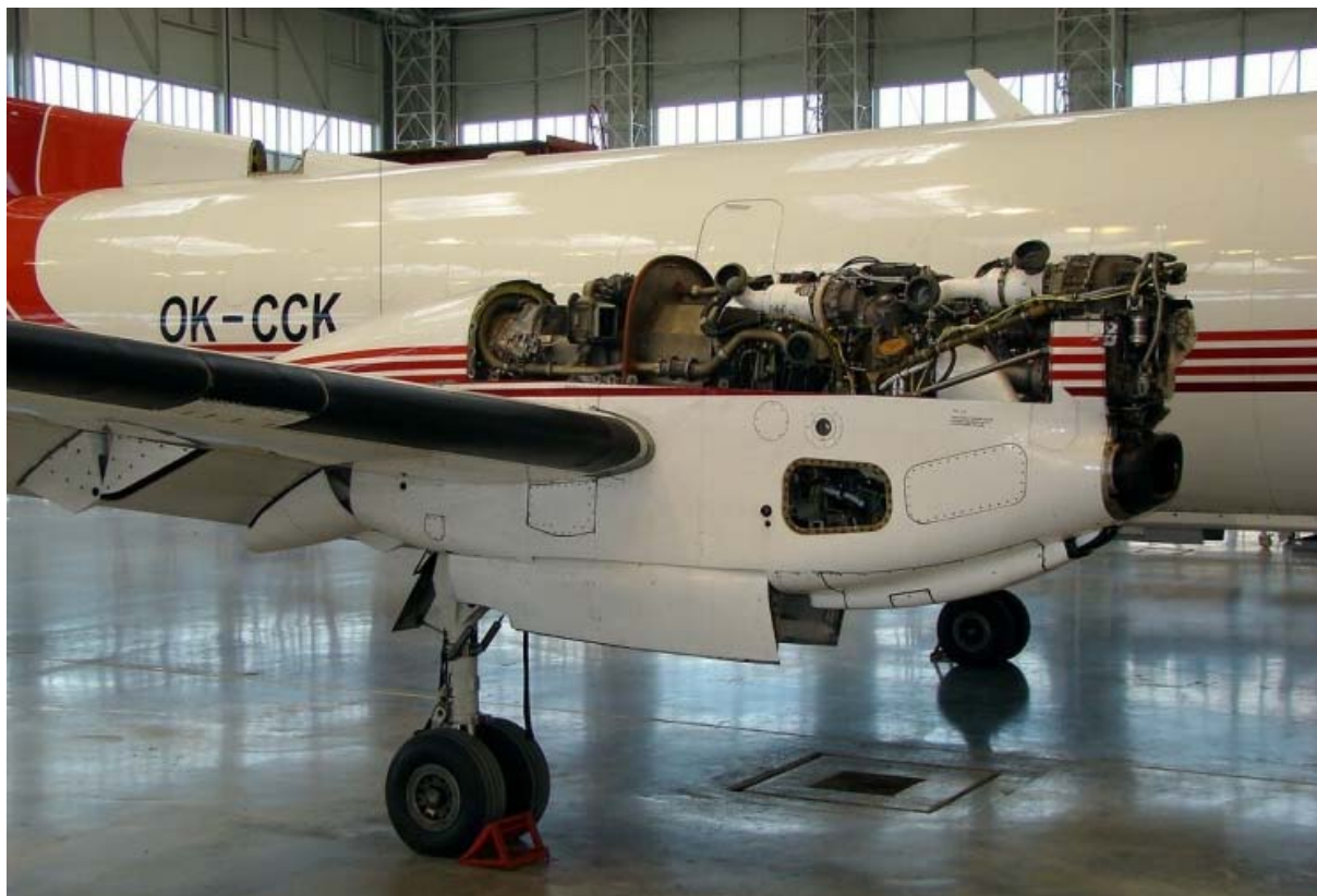
Obr. 8 Údržba motoru letadla SAAB 340 A
