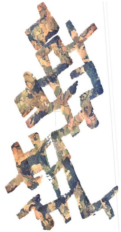
Obrázek 11 – Husté bodové mračno ze snímků s nedostatečným překryvem
