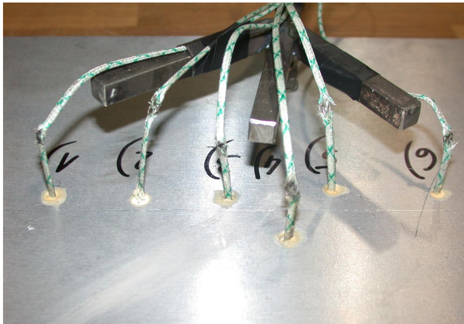
Obr. 16: Umístění termočlánků na svařenci
