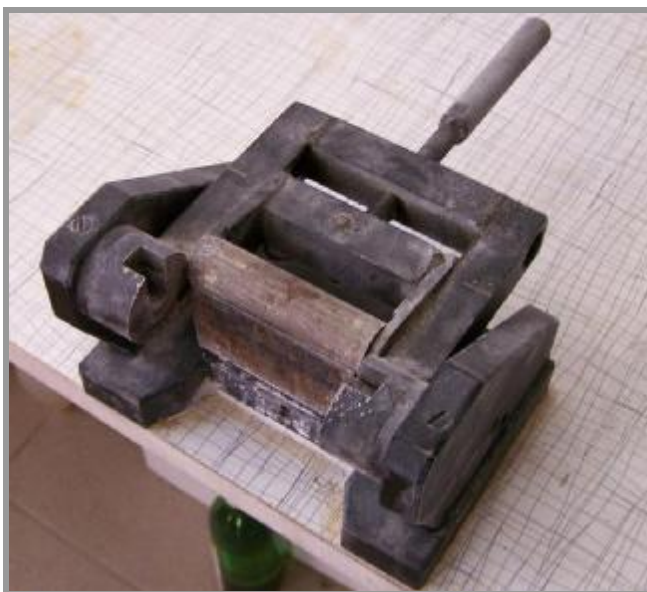
Obr. 6-10 Použité ohýbací zařízení
