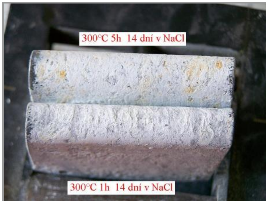
Obr. 6-13 Vliv podmínek ohřevu na přilnavost zinkové vrstvy II.
