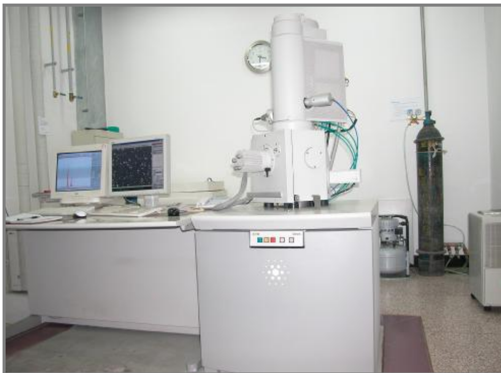
Obr. 6-35 SEM mikroskop PHILIPS XL-30 na VUT v Brně [21]
