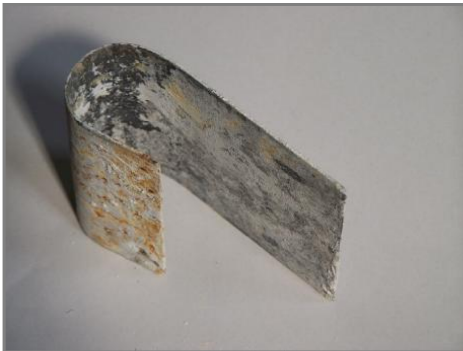
Obr. 6-14 Odlupování povlaku na vnitřní straně vzorku
