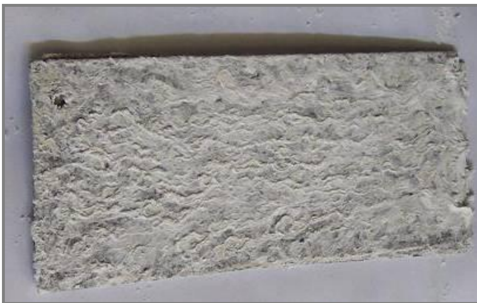
Obr. 6-6 Vzorek po třech dnech v prostředí solné mlhy
