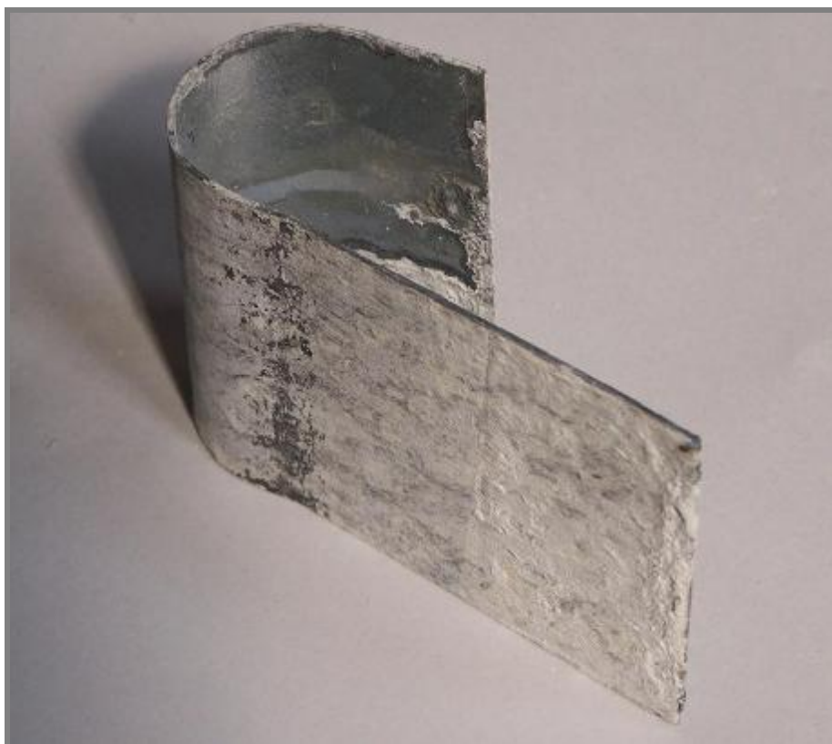
Obr. 6-15 Vnitřní strana vzorku exponovaného po dobu 1 hodiny
