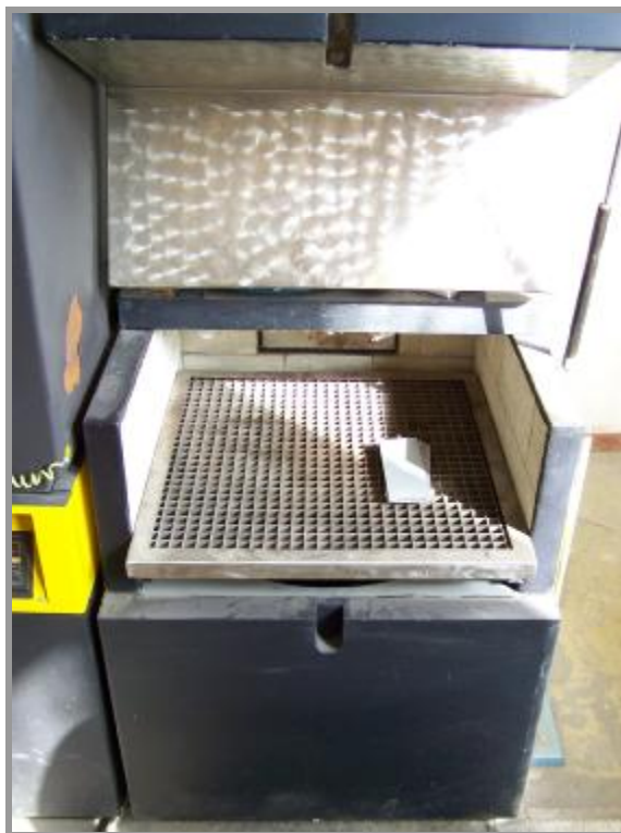
Obr. 6-3 Chladicí zařízení pro popuštěné vzorky
