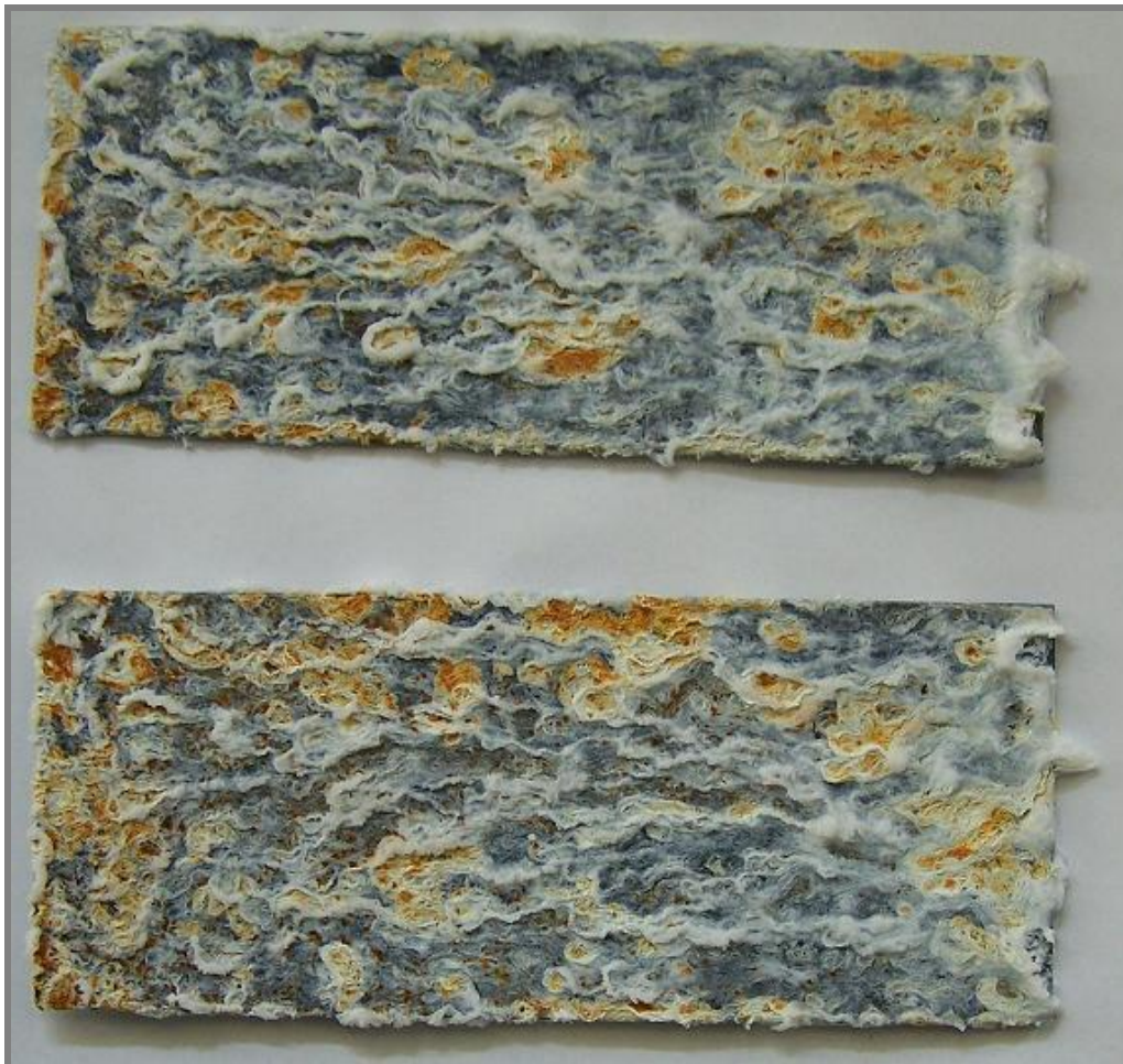
Obr. 6-8 Vzorky po čtrnácti dnech v prostředí solné mlhy
