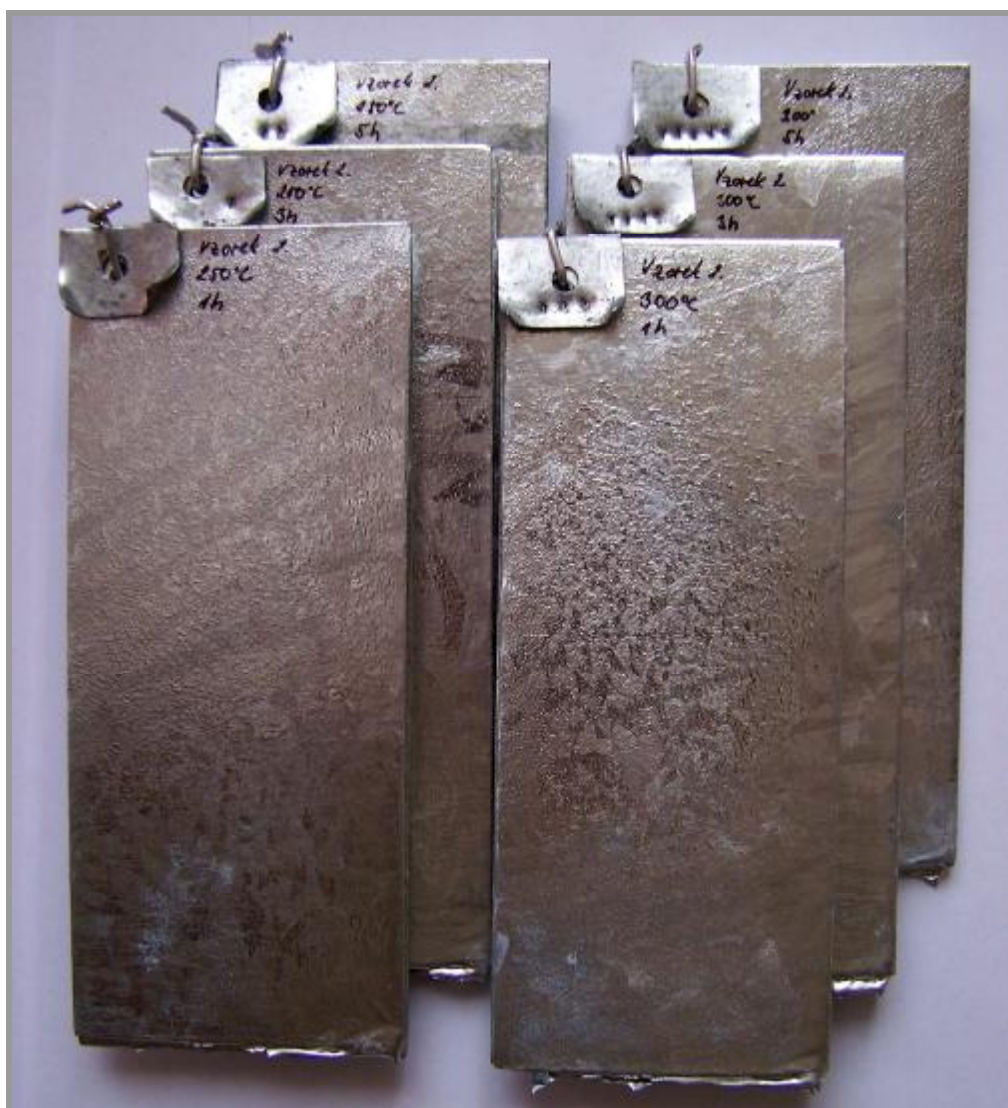
Obr. 6-1 Připravená a označená sada vzorků
