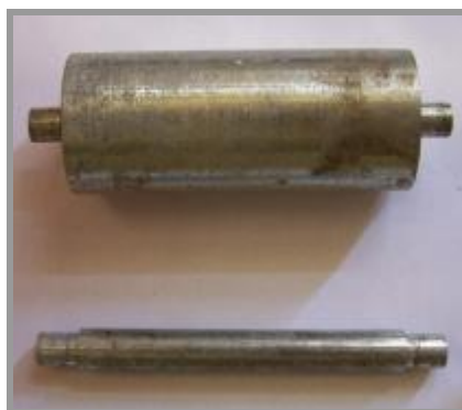
Obr. 6-11 Použité trny - \varnothing 10 a \varnothing 32
