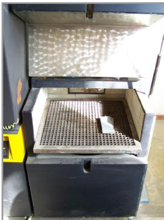
Obr. 6-3 Chladicí zařízení pro popuštěné vzorky
