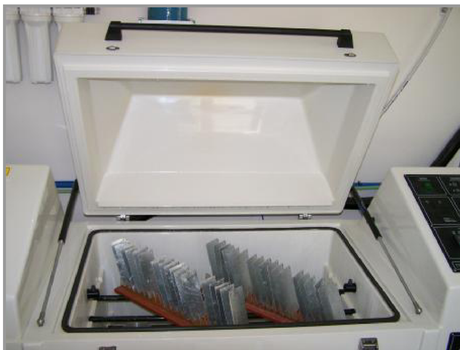
Obr. 6-5 Připravené vzorky v solné komoře od firmy Liebisch
