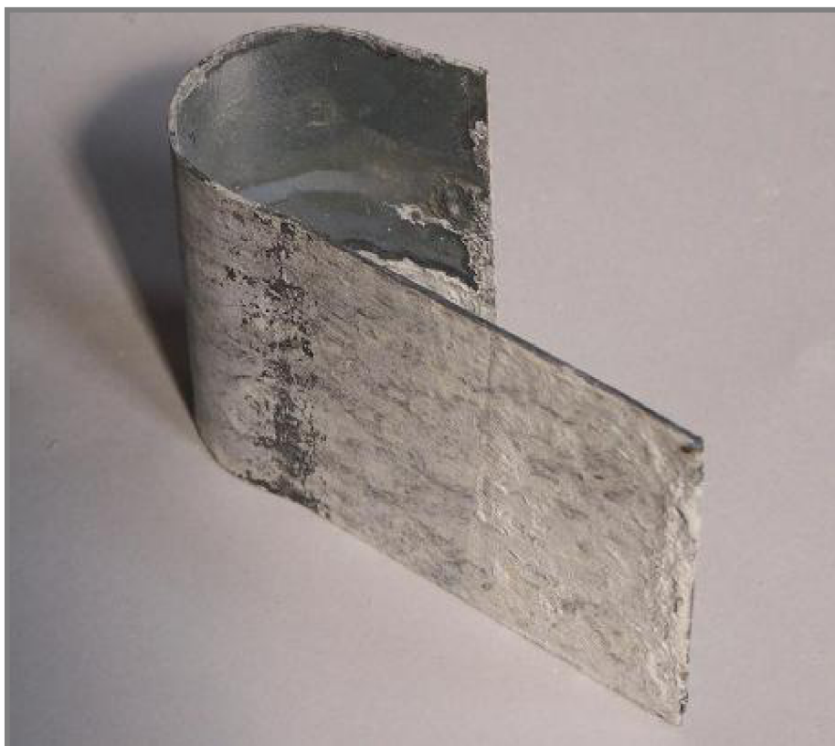
Obr. 6-15 Vnitřní strana vzorku exponovaného po dobu 1 hodiny
