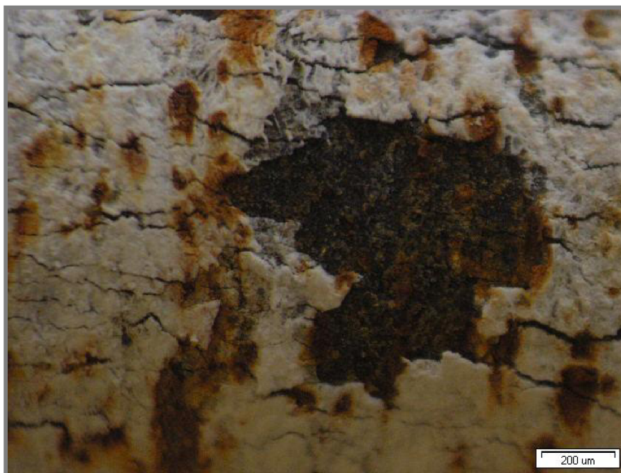
Obr. 6-28 Tahová str. vzorku s praskl. a červ. korozi (žih. 5h při 250°C, trn Ø 10 mm, 16x)
