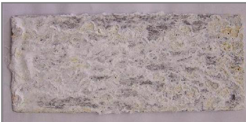
Obr. 6-7 Vzorky po sedmi dnech v prostředí solné mlhy
