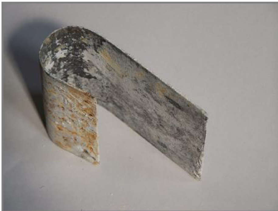
Obr. 6-14 Odlupování povlaku na vnitřní straně vzorku
