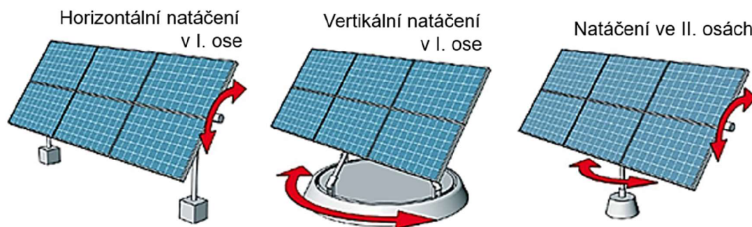
Obrázek 16 – Hlavní typy používaných natáčecích systému [56]
