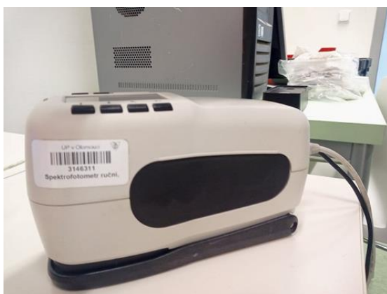
Obr. 10: Ruční spektrometr SP 62 (X-Rite, USA; fotografie vlastní).
