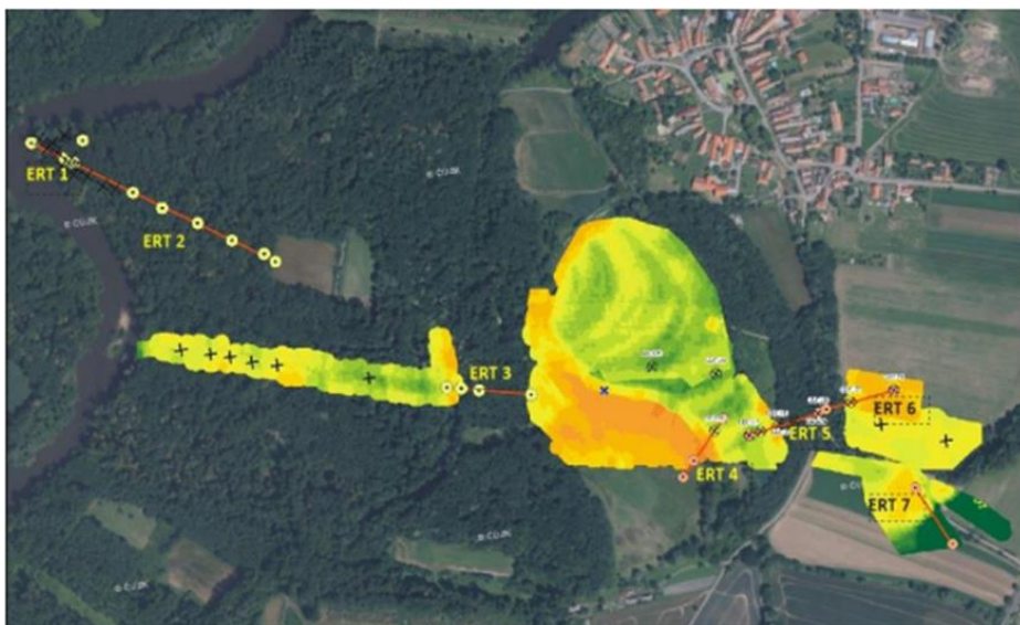
Obr. 6: 2D vizualizace DEMPU, vyznačení ERT profilů a půdních sond (Sekanina et al., 2018).
