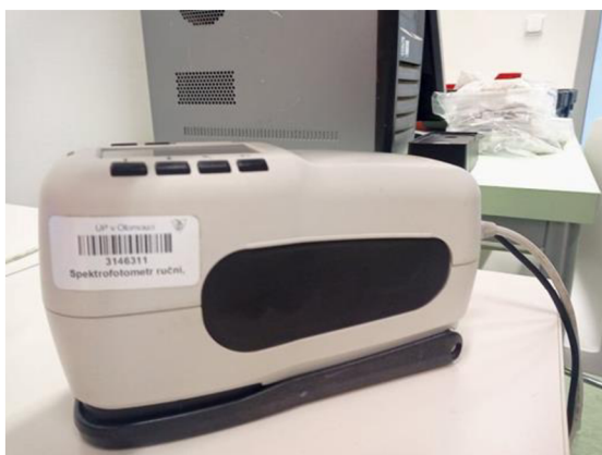
Obr. 10: Ruční spektrometr SP 62 (X-Rite, USA; fotografie vlastní).
