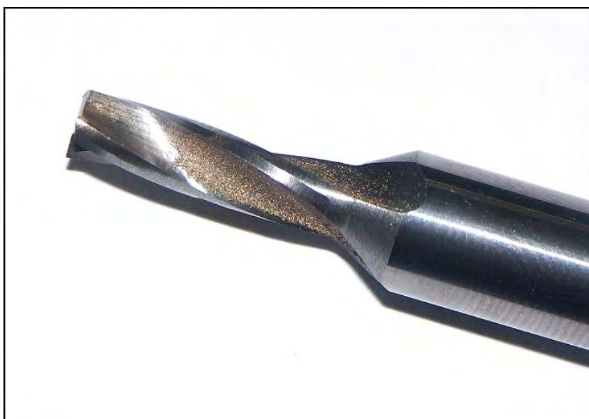
Obr. 5.2. Spirálový vrták s rovným čelem \varnothing 4,1 mm.
