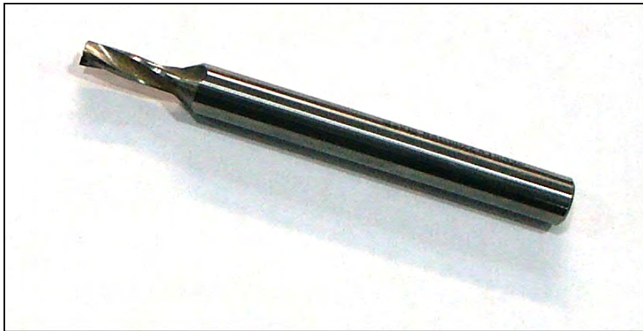
Obr. 5.3. Spirálový vrták s rovným čelem \varnothing 2,1 mm.
