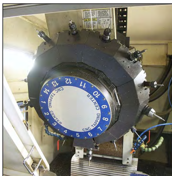
Obr. 3.15. Revolverová hlava stroje Brother TC – 324 N.
