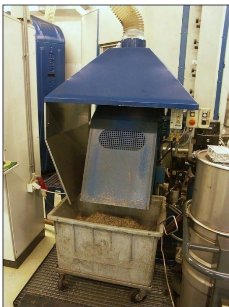
Obr. 3.5. Odvod třísek Mini FLEXu.
