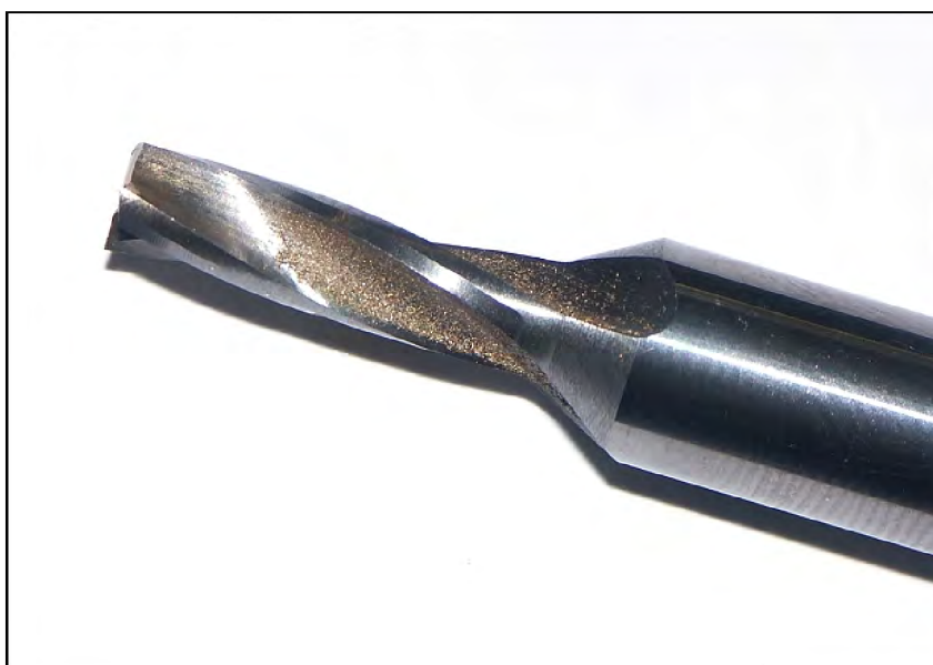
Obr. 5.2. Spirálový vrták s rovným čelem \varnothing 4,1 mm.
