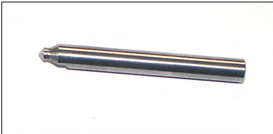
Obr. 5.4. Tvarový vrták \varnothing 4,2 mm a zaoblení hrany otvoru R 1,5 mm.
