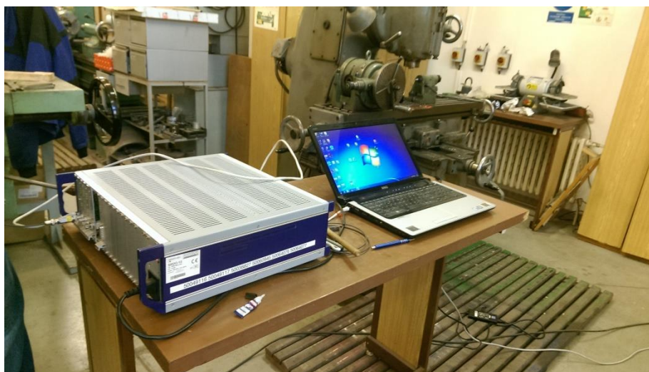
Obr. č. 29 Použitý měřicí systém pro detekci akustické emise
