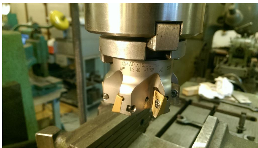
Obr. č. 28 Použitý obráběcí nástroj (fréza s vyměnitelnými břitovými destičkami)
