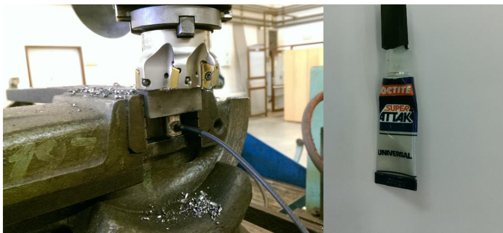
Obr. č. 32 Umístění snímače na obráběný materiál, použité lepidlo
