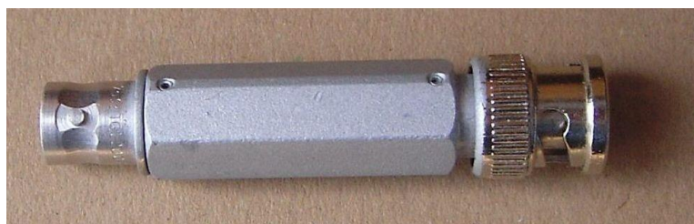
Obr. č. 25 Vnější konstrukce předzesilovače (dakel.cz)
