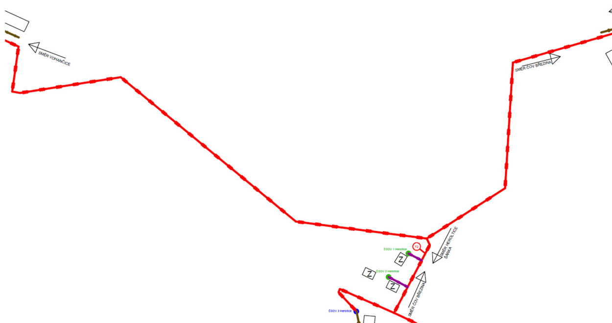
Obr. 12 Schéma „propoje“ výtlačků z Vohančic a Heroltic do Březiny
