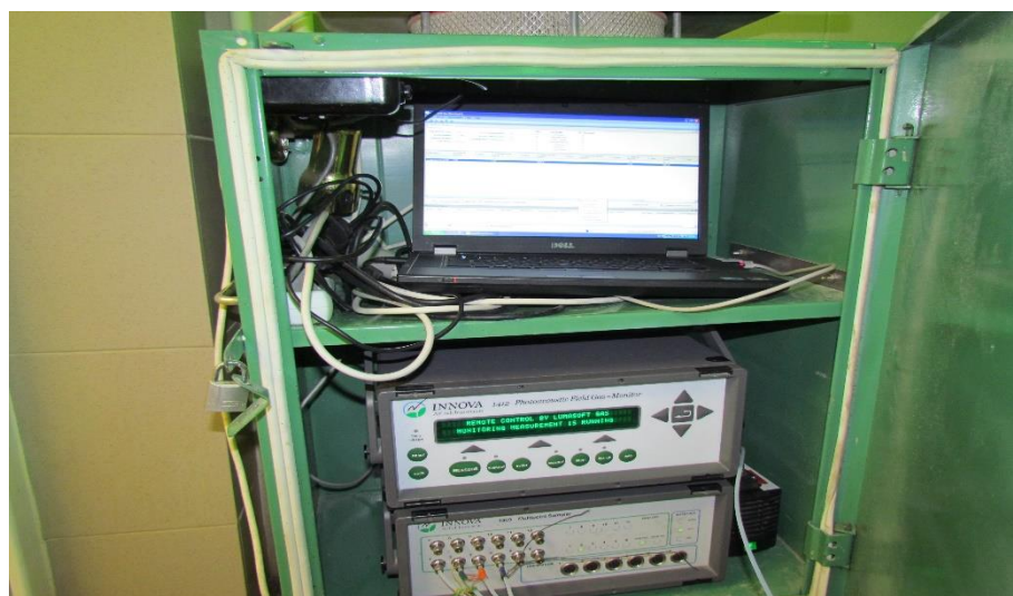
Obrázek č. 10 - Přístroj INNOVA 1412 Photoacoustic Multi-gas Monitor s vícekanálovým vzorkovacím a dávkovacím zařízením 1309 D Multipoint Sampler
