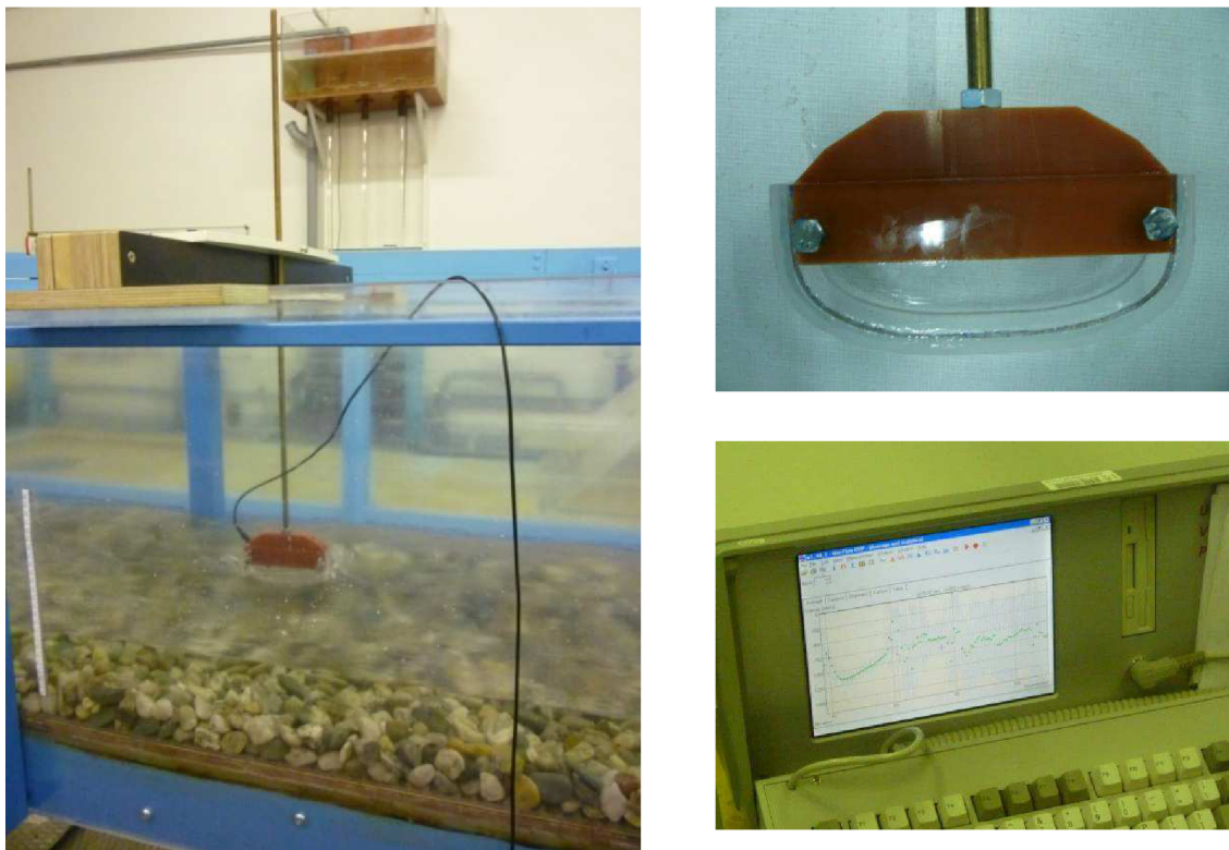
Obr. 4.1 Vlevo měření bodových rychlostí protiproudě natočenou sondou umístěnou v měřidle, vpravo detail měřidla a ukázka změřených bodových rychlostí po délce UV paprsku UVP Monitorem
