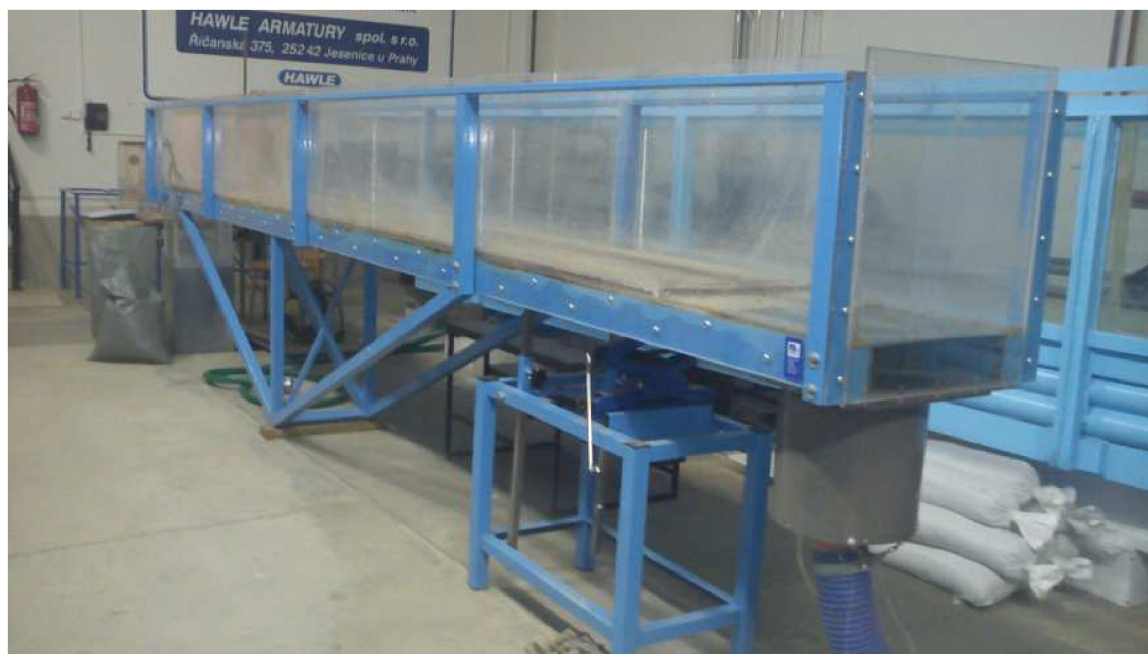
Obr. 3.2 Pohled na sklopný žlab, v popředí žlabu nátok s polohovacím zařízením žlabu
