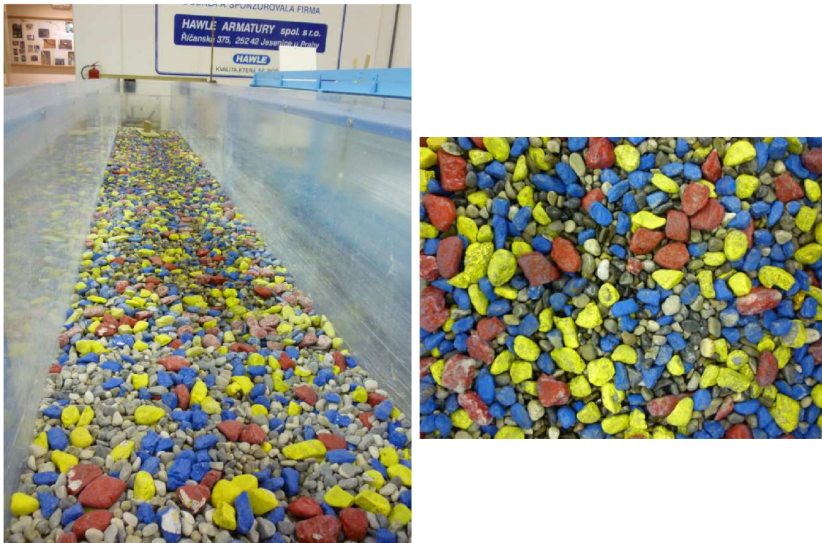
Obr. 5.8 Nestejnozrnný materiál. Vlevo pohled na uložená zrna ve žlabu. Vpravo zobrazený kontrolní profil. Červená barva frakce 25–31,5; žlutá barva frakce 20–25; modrá barva frakce 16–20; frakce menší nejsou nabarveny
