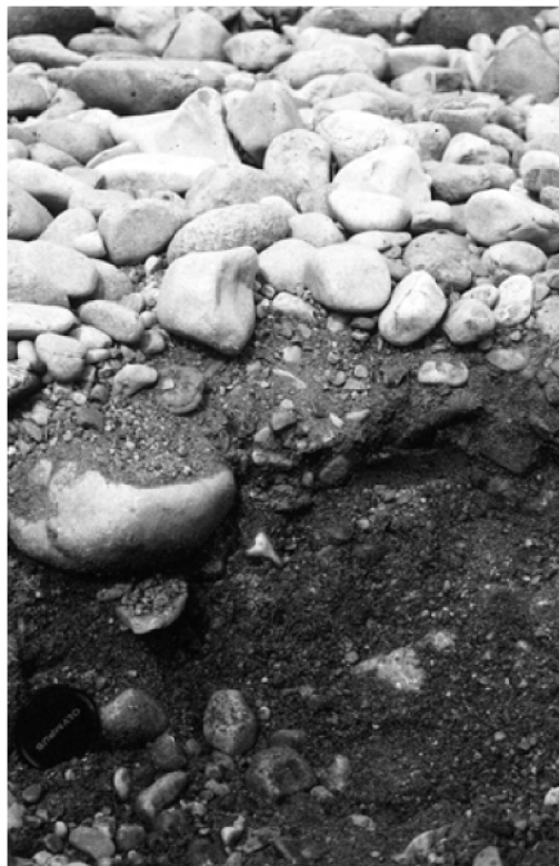
Obr. 5.1 Ukázka vytríděné krycí vrstvy uložené na spodní vrstvě řeky Wharfe (Velká Británie), foto Parker (García, 2008)
