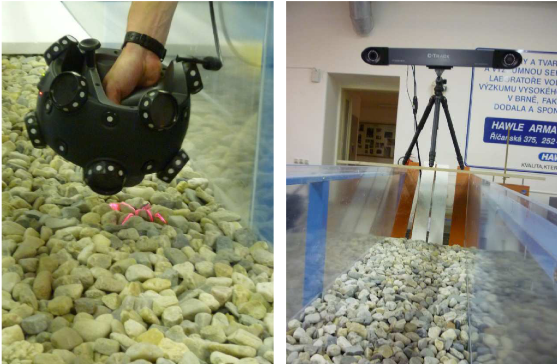
Obr. 4.4 Vlevo skenovací hlava s pozičními značkami. Vpravo duální kamerové snímače
