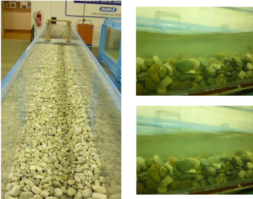
Obr. 3.3 Vlevo pohled do žlabu na urovnaný materiál, vpravo tloušťka vrstvy materiálu a transport splavenin v krátkém časovém intervalu
