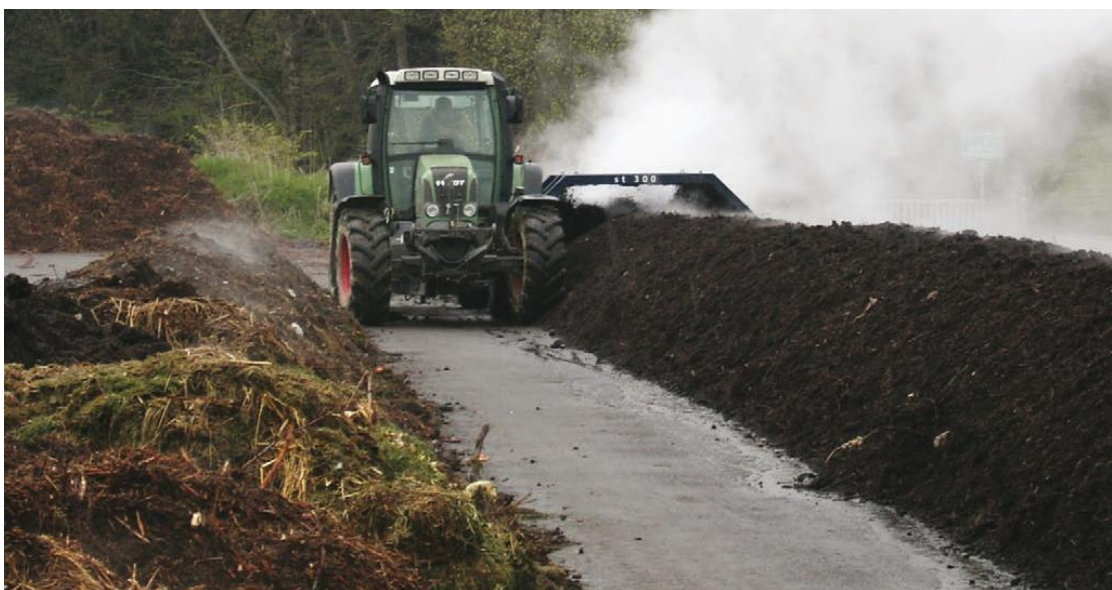
Obr.1 Kompostování na pásových hromadách
