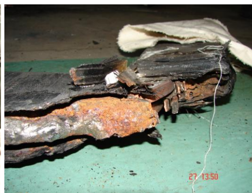
Obr. č. 27 Zkratem poškozená tyč vinutí
