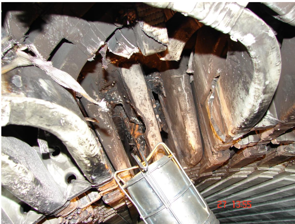
Obr. č. 25 Vytavení magnetického obvodu
