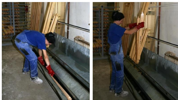
Obr. 5.8 Máčení dílců v máčecí vaně (Soukup)
