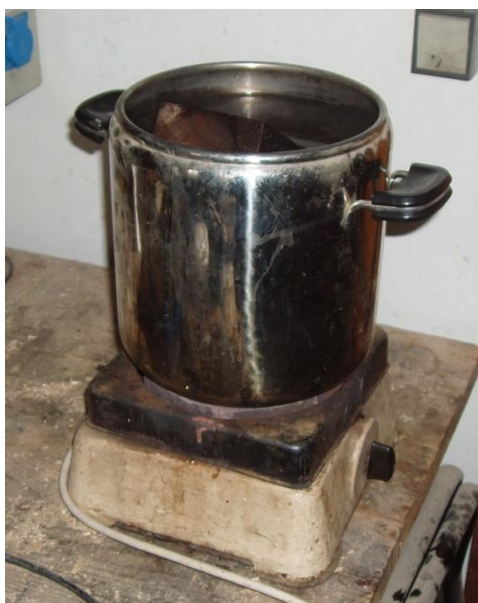
Obr. 6.8 Vaření zkušebních těles
