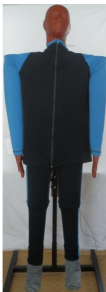
Obrázek 5: Tepelný manekýn "Karel" - oblečený do zkušebního oděvu [15]
