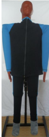
Obrázek 5: Tepelný manekýn "Karel" - oblečený do zkušebního oděvu [15]
